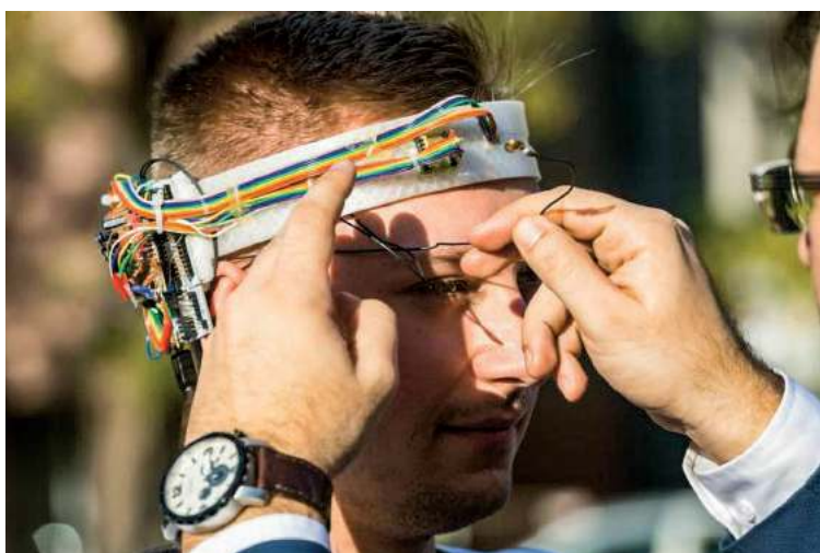
Wynalazek mierzy przyspieszenia działające na głowę człowieka i aktywność elektryczną kory mózgowej | fot. mat. pras. PWR/d
