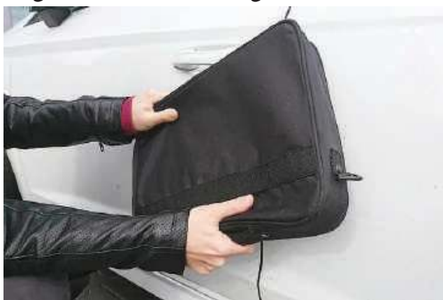
Urządzenie z przechwyconym sygnałem, ukryte w walizce, złodziej przykład do drzwi, a te po chwili zostają otwarte.
