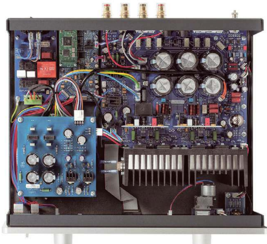
Wnętrze CSA 150 łączy różne techniki: tranzystorową i lampową, analogową i cyfrową.
