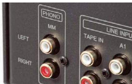
Jest wejście gramofonowe – podstawowe dla wkładek MM
