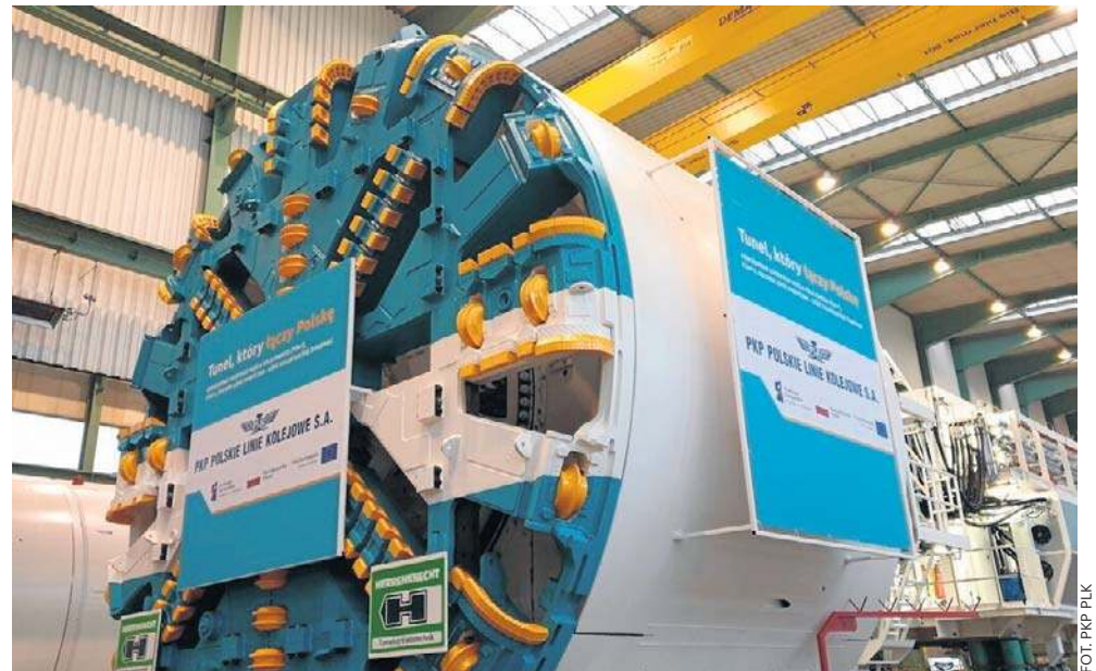
Tak wygląda tarcza, która pracuje pod kamienicami na Legionów. Obecnie tarcza TBM znajduje się pomiędzy budynkami przy ul. Legionów 57 i ul. Legionów 59
