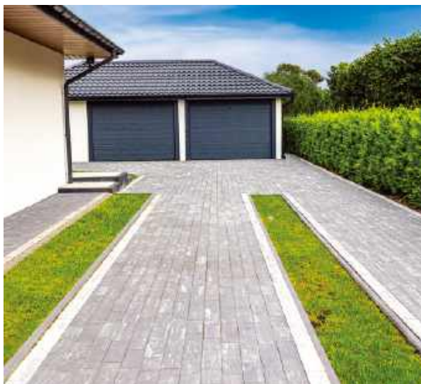
🔧 Obrzeża zapobiegają rozchodzeniu się nawierzchni na boki, są niezbędne zarówno na ścieżkach jak i na podjazdach. VESTONE
