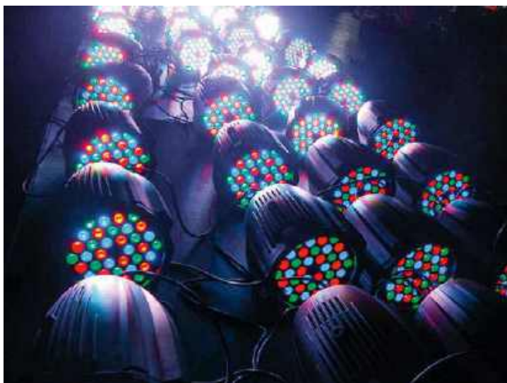
Diody – jeśli nie są to białe diody uzyskane z promieniowania ultrafioletowego – nie emitują promieniowania UV, co może być szczególnie ważne w zastosowaniach muzealnych itp.
