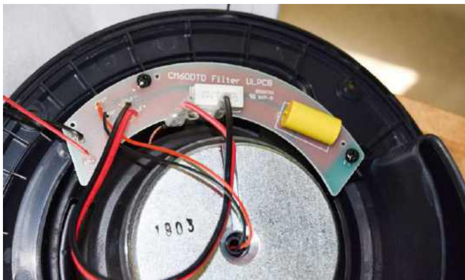
Na wewnętrznej stronie ścianki głośników zamontowana jest płytka drukowana zwrotnicy.
