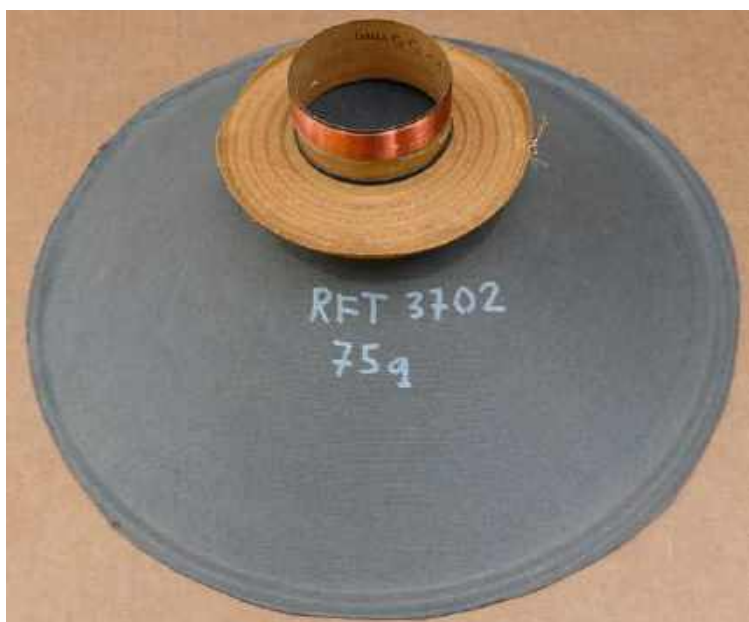
Oryginalna membrana i cewka głośnika RFT 3702.
