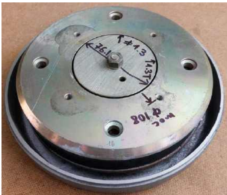
Obwód magnetyczny umieszczono wewnątrz aluminiowej osłony.
