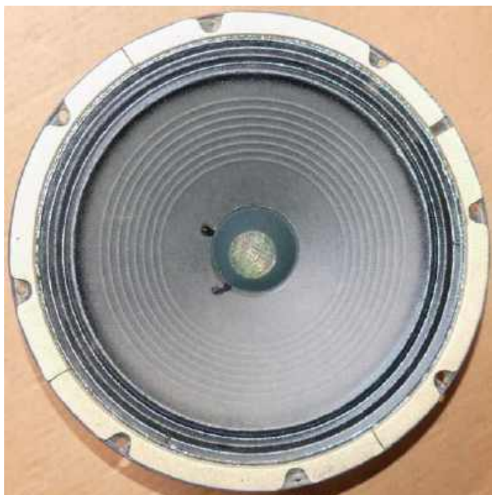
Zastosowano typową membranę gitarową, z papierowym górnym zawieszeniem.
