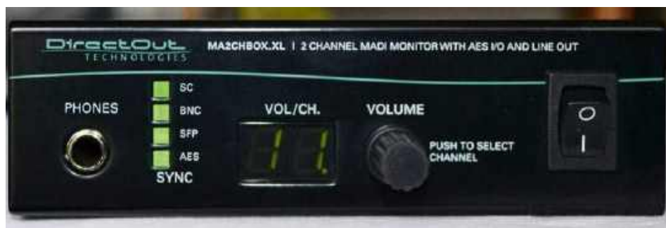
Z przodu znajduje się wyłącznik zasilania, obrotowy enkoder z przyciskiem, dwucyfrowy wyświetlacz numeryczny, cztery diody LED i jedyne gniazdo – słuchawkowe typu jack 1/4" TRS.
