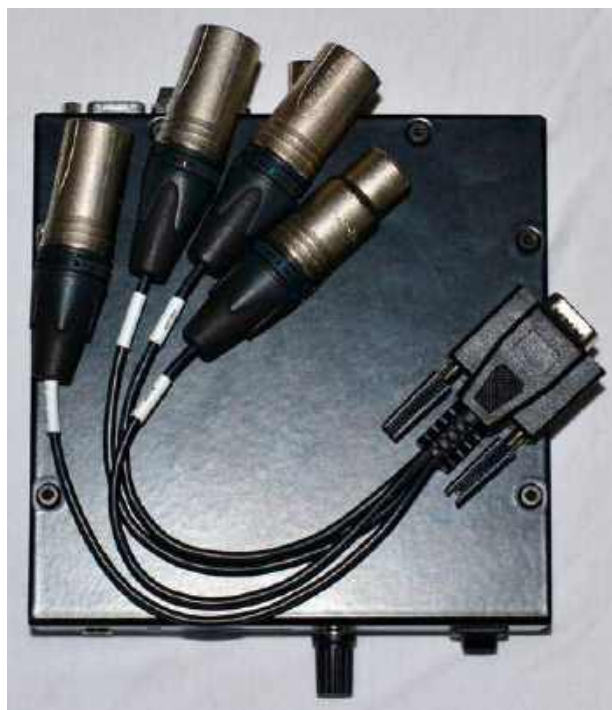
W zestawie wraz z urządzeniem producent dołącza przejściówkę z DB9 na cztery XLR-y: trzy męskie (wyjścia liniowe lewy-prawy i AES3) i jedno żeńskie (wejście AES3).
