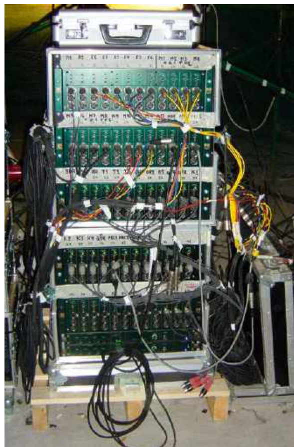
Warto przed „sztuką” dobrze przyjrzeć się konfiguracji splittera, szczególnie zwracając uwagę na położenie przełączników groundlift.
