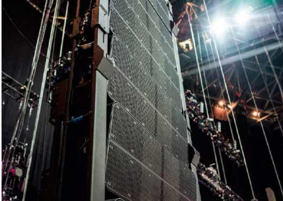
Wszystkie moduły mogą być obracane wokół swojej osi poziomej, aby uzyskać odpowiednie nachylenie, dla uzyskaniażądanego pokrycia.
