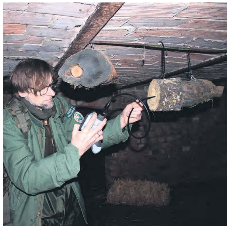
Monitoring przy użyciu kamery inspekcyjnej. Fot. Bartłomiej Szamocki
