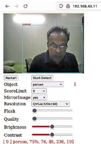
Rysunek 6. Wyjście obrazu z kamery pokazujące detekcję osoby oraz dostępne atrybuty obrazu
