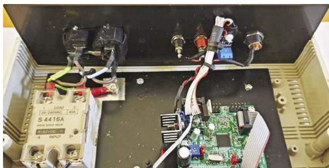
Widok połączeń na tylnym panelu – ponownie przypominamy, że jest to widok przed założeniem osłony izolacyjnej z preszpanu. Nie zapomnij o niej! Użycie czerwonej opaski termokurczliwej na żółto-zielonym przewodzie uziemienia jest złamaniem wszystkich zasad dobrej praktyki warsztatowej!
