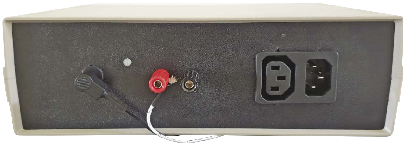
Na tylnej ścianie znajduje się gniazdo wejściowe 9 V DC (po lewej), a obok niego dedykowane zaciski termopary. Na prawym końcu znajduje się podwójne przyłącze sieciowe IEC: wejściowe i wyjściowe, które jest sednem tego projektu; sieć zasilająca dochodzi do prawego (męskiego) wtyku; nadzorowane/sterowane zasilanie do piekarnika tostowego pobierane jest z lewego (żeńskiego) gniazda.
