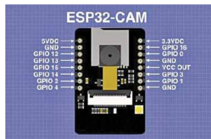
Rysunek 3. Szczegóły wyprowadzeń modułu ESP32
