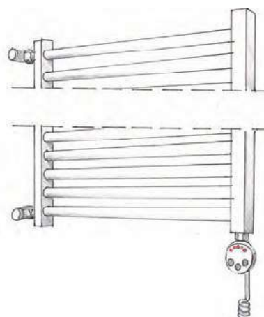
❹ Rys. 4 Podłączenie boczne grzejnika. Grzałkę należy umieścić wówczas po jego przeciwnej stronie.
