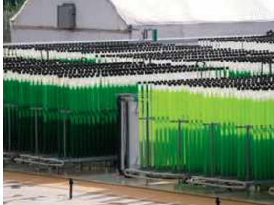
Farma glonów w przezroczystych fotobioreaktorach rurowych – nowoczesna metoda hodowli w kontrolowanych warunkach
