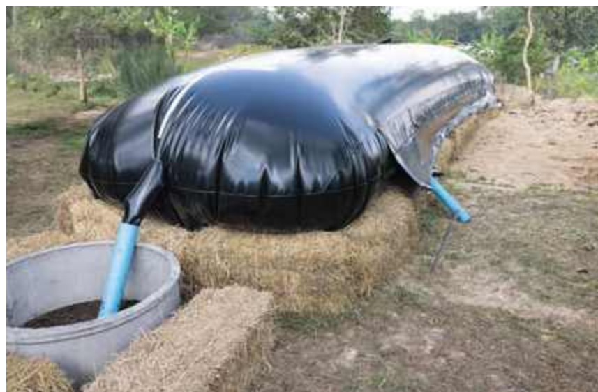
Mała biogazownia na farmie trzody chlewnej – prosta instalacja do produkcji energii odnawialnej
