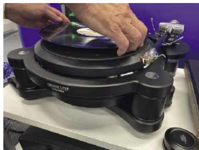
Voyager to najlepszy gramofon Origin Live; w wersji S (na zdjęciu), wprowadzonej 2 lata temu, dodano więcej warstw tłumiących, poprawiono zasilacz, łożysko i talerz; jego charakterystyczna konstrukcja ma rozproszyć rezonanse samej płyty winylowej.
