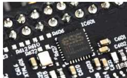
Przetwornik C/A we wszystkich urządzeniach serii 40 jest taki sam – to doskonały układ ESS Technology ES9039Q2M.
