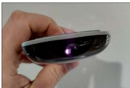
Fot. 1. Prosta metoda weryfikacji czy pilot wysyła sygnał IR. Kamera smartfona widzi działającą przy wciskaniu przycisków diodę Źródło: własne
