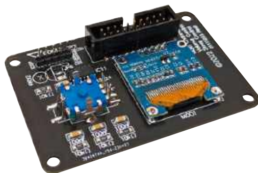
Na fotografii pokazano sposób zamocowania enkodera obrotowego i wyświetlacza OLED do płytki drukowanej. Oba elementy są połączone z płytką za pomocą krótkich odcinków przewodów, wykonanych na przykład z odciętych wyprowadzeń elementów. Widać również sposób montażu złącza CON13 przeznaczonego do programowania mikrokontrolera w układzie (ICSP)
