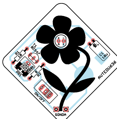
Rysunek 2. Schemat montażowy układu. Uchwyt baterii to element do montażu powierzchniowego (SMD), który należy zamontować po stronie lutowania, pozostałe elementy do montażu przewlekane (THT) należy zamontować po stronie przeciwnej
