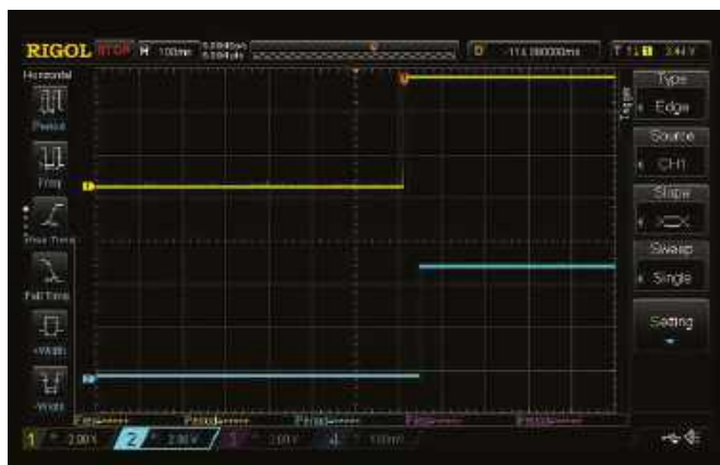
Rysunek 7. Enkoder o 30 kliknięciach. Z lewej: obrót pokrętki o jeden klik w prawo, po prawej: obrót o kolejny klik w prawo
