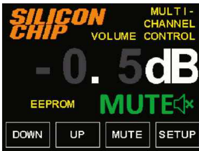
Ekran 4. Widok wyświetlacza przy aktywnej funkcji MUTE. Żółty napis „EEPROM” oznacza, że bieżące ustawienia nie zostały jeszcze zapisane w pamięci EEPROM. Po 10 sekundach braku aktywności ustawienia zostaną zapisane automatycznie i przywrócone po wyłączeniu oraz ponownym włączeniu regulatora głośności
