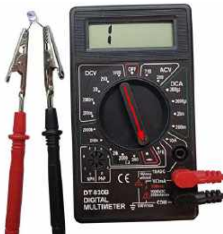
Fotografia 3. Sprawdzanie diody LED za pomocą multimetru ustawionego na funkcję testowania diod. Po przyłożeniu sondy czerwonej do anody, a czarnej do katody, sprawna dioda LED powinna się zaświecić. Jeśli dioda ma odpowiednio długie (jeszcze nie przycięte) wyprowadzenia można się wspomóc krokodylkami
