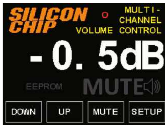
Ekran 1. Jeśli po włączeniu wielokanałowego regulatora głośności pojawi się taki ekran, oznacza to, że moduł sterujący działa prawidłowo. Czerwone kółko w prawym górnym rogu jest wskaźnikiem odbioru sygnału podczerwieni (IR) i pojawia się po odebraniu sygnału z pilota, niezależnie od tego, czy został on rozpoznany przez urządzenie
