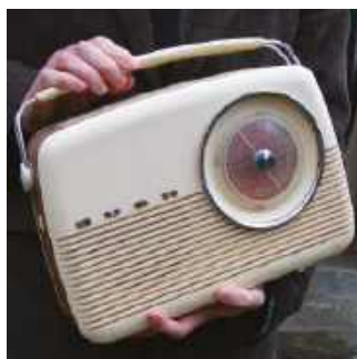
Rysunek 6. W stylowym radiu Bush TR82 zastosowano potencjometry Plessey z serii E. Te radia rzadko ulegają awarii. Wymagają jedynie czyszczenia i wymiany starych kondensatorów elektrolitycznych na nowe
