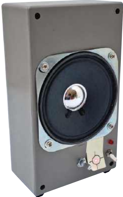
Fotografia 2. Obudowa odbiornika pełni jednocześnie funkcję przegrody głośnikowej. Karteczka samoprzylepna z narysowanym celem jest istotnym elementem, ponieważ ułatwia celowanie i rozprasza światło lasera, dzięki czemu ustawienie łącza jest znacznie łatwiejsze (dobrze sprawdzi się również taśma maskująca)
