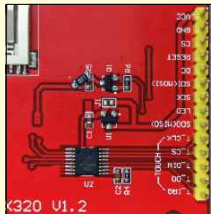
Rysunek d i e. W modułach LCD w wersji V1.2 konieczne było usunięcie fragmentu maski lutowniczej, aby umożliwić montaż rezystora o odpowiedniej wielkości w miejscu R5
