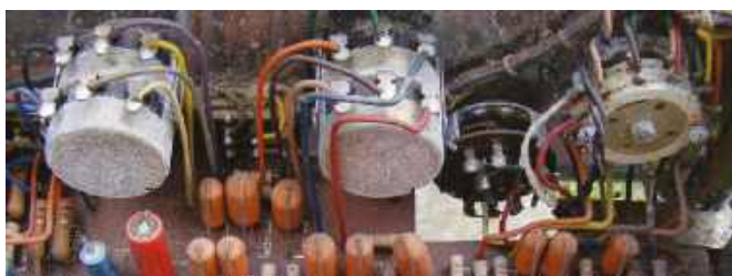
Rysunek 3. We wczesnych urządzeniach Hi-Fi stosowano potencjometry ze ścieżką węglową firmy Morganite. Znalazły one zastosowanie we wzmacniaczu Leak Stereo 30 z 1964 roku, zbudowanym na tranzystorach germanowych. Nadal działają pomimo utlenienia i zabrudzeń
