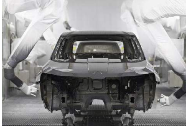
Nakładanie kolejnej warstwy lakieru przez roboty
