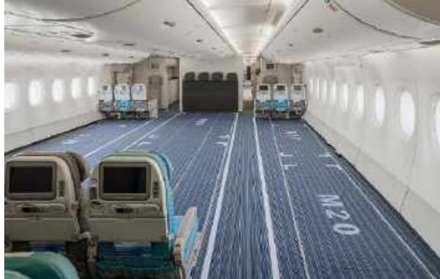
3. Wnętrze A380 linii Hi Fly w konfiguracji cargo
