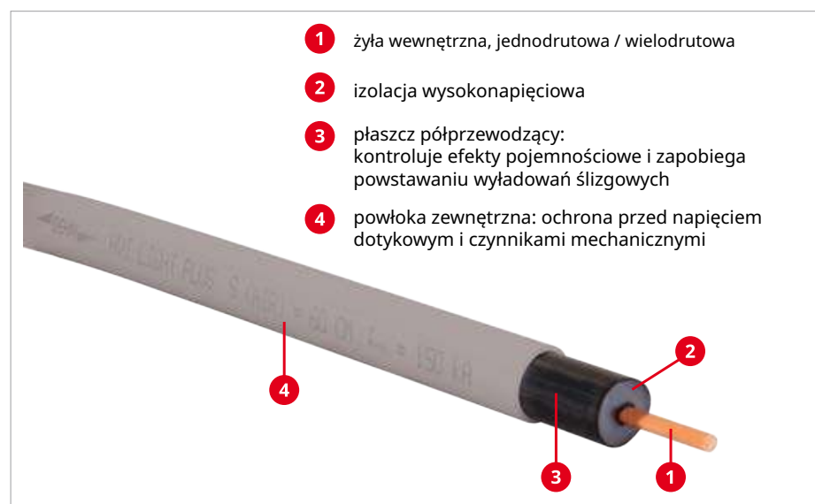
Rys. 2. Budowa przewodu HVI light plus
