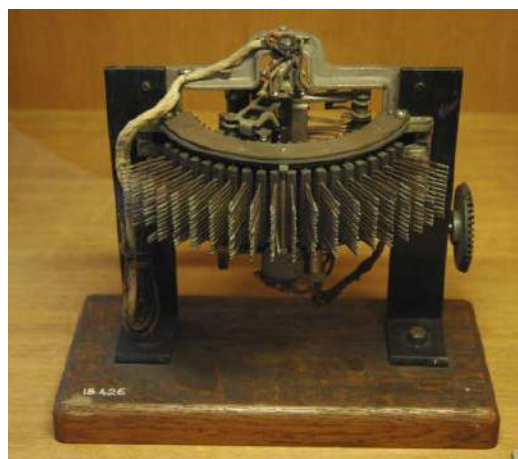
2. Łącznica Strowgera – rekonstrukcja
