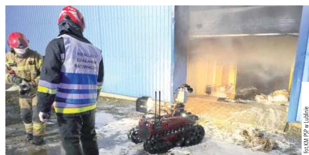
Strażacy wykorzystali robota gaśniczego, który wyposażony w linię gaśniczą został wprowadzony do wnętrza budynku
