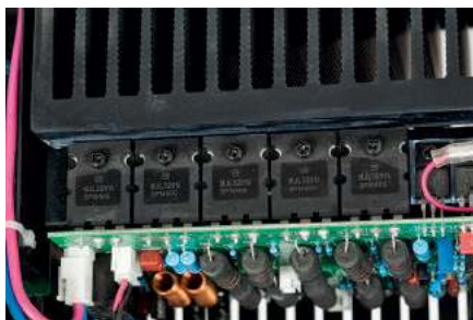
W końcówkach mocy pracują tranzystory bipolarnie marki ON Semiconductor.
