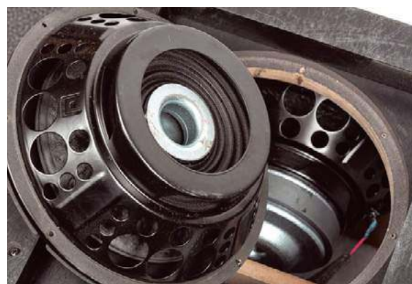
Na tym zdjęciu dobrze widać, że membrana bierna jest dociążona pierścieniem dołączonym tam, gdzie w normalnym głośniku znajduje się cewka.
