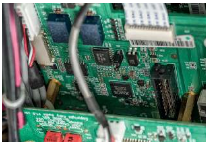
Sygnałami ze złącza USB opiekuje się układ XMOS, przetwornik to również popularny C/A AKM AK4490EQ.
