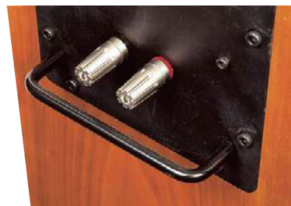
Gniazdo przyłączeniowe jest pojedyncze, ale zamontowane na bardzo dużej płycie i – co jeszcze bardziej zaskakujące – z szerokimi rączkami służącymi „nie wiadomo do czego”, bo przecież nie do przenoszenia kolumn...
