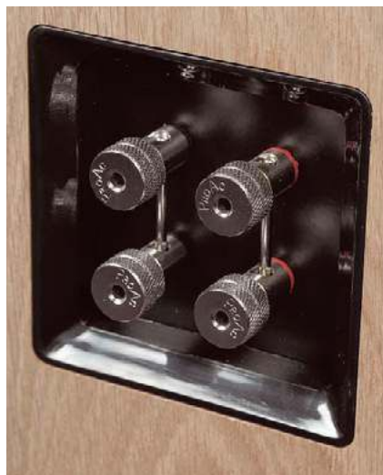
Całkowicie metalowe zakrętki, dwie pary do bi-wiringu, zwory z prętów, terminal w zagłębieniu tylnej ścianki – kto zna, ten pozna.
