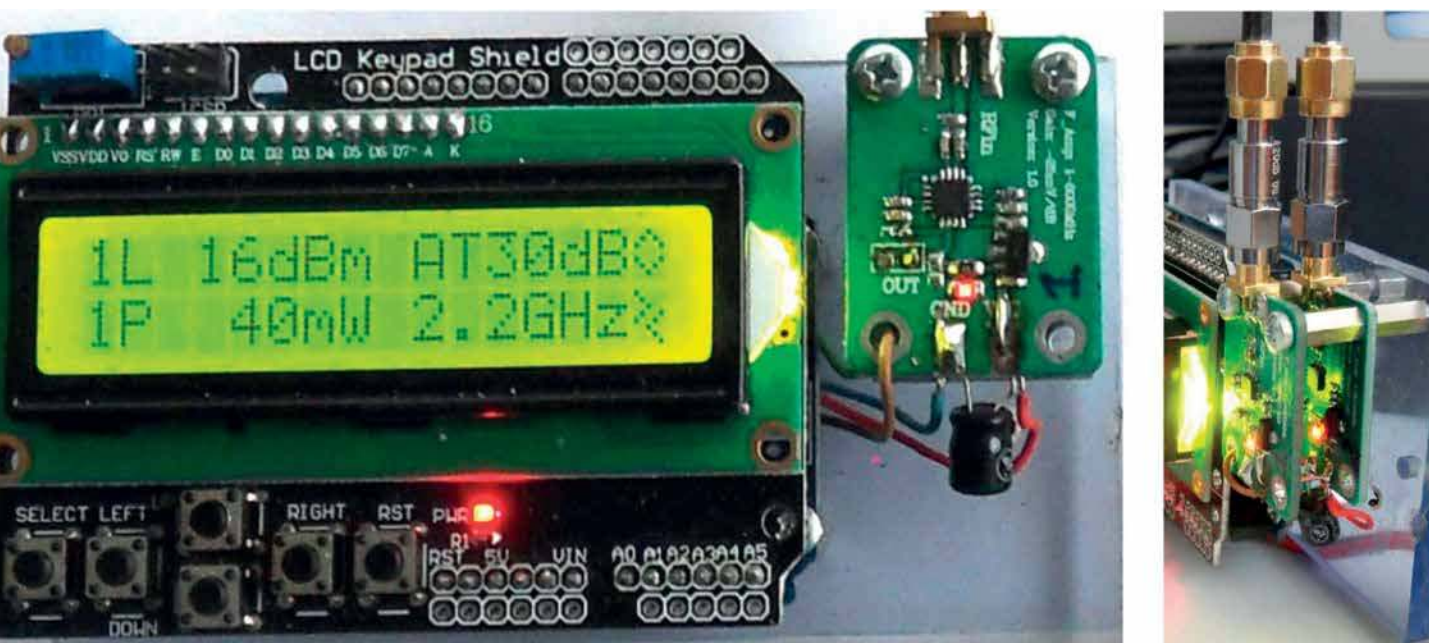
Rys. 2. Arduino Uno podłączone do dwóch modułów AD8318
