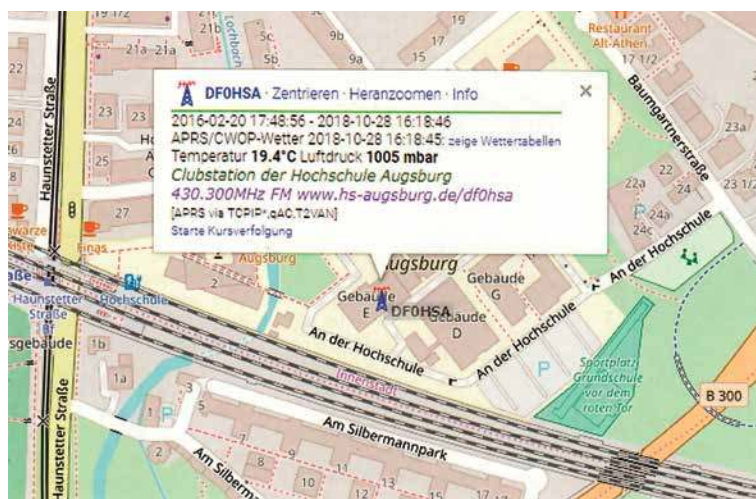
Rys. 2. Przykładowy komunikat stacji klubowej zawiera oprócz podstawowych informacji o niej meldunek o temperaturze i ciśnieniu atmosferycznym. Położenie stacji jest widoczne na tle mapy OpenStreetMap
