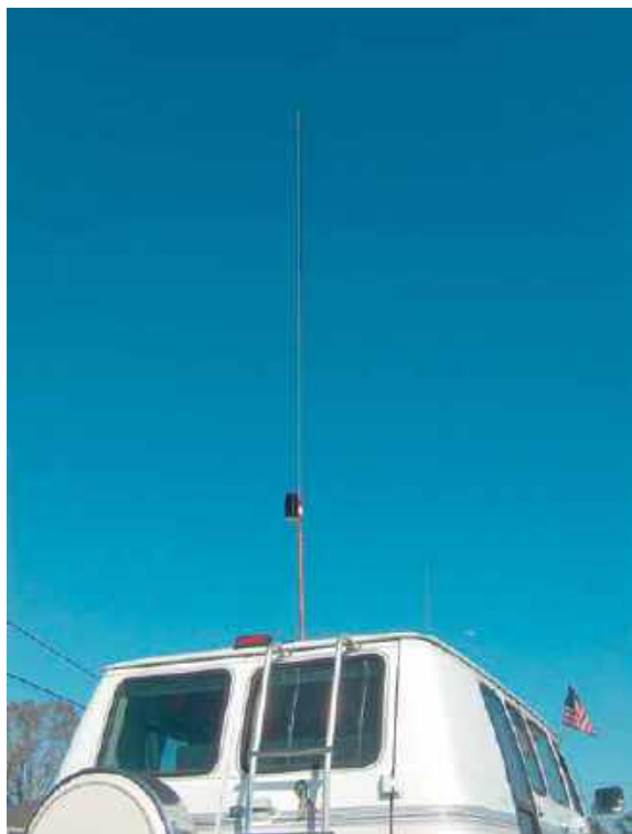
Antena z cewką na pasmo 40 m na dachu samochodu
