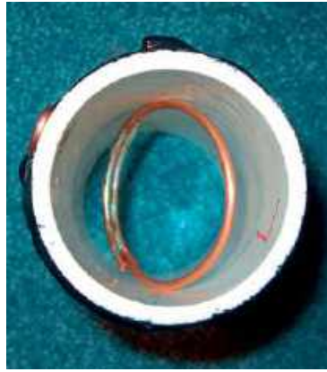
Pierścień strojący wewnątrz cewki na pasmo 7 MHz jest wykonany z rurki miedzianej, strojenie cewki polega na jego obracaniu. Może okazać się niepotrzebny albo przydatny tylko w niektórych pasmach
