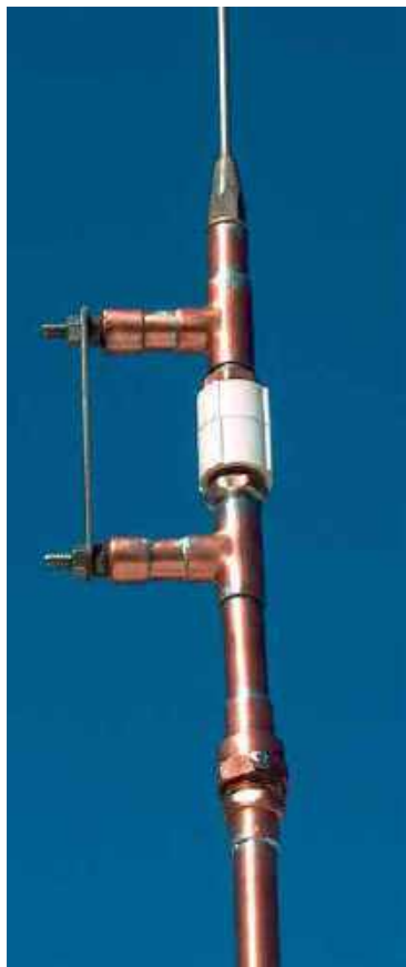
Zwora dla pasm 10–15 m. Poniżej widoczna nakrętka łącząca dwie części dolnego segmentu anteny pozwalająca na ustawienie cewki z tyłu. Śruba zapewnia utrzymanie anteny w tej pozycji
