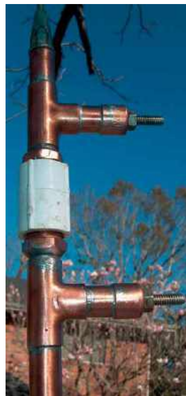
Środkowa część anteny: izolator z PCW i rozgałęźniki do montowania cewek
