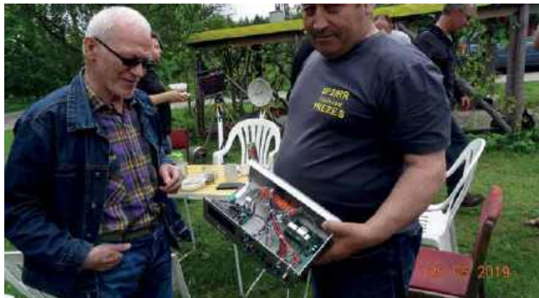
Zdzisław SP2IRR prezentuje sterownik OE5JFL do swojej anteny EME. Na drugim planie mała paraboliczna antena z TRV na pasmo 76 GHz oraz urządzenie do łączności na falach świetlnych (dioda 0,7 W czerwona)
