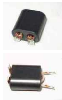
Transformator wejściowy TR1 (zdjęcia pochodzą z Internetu)
