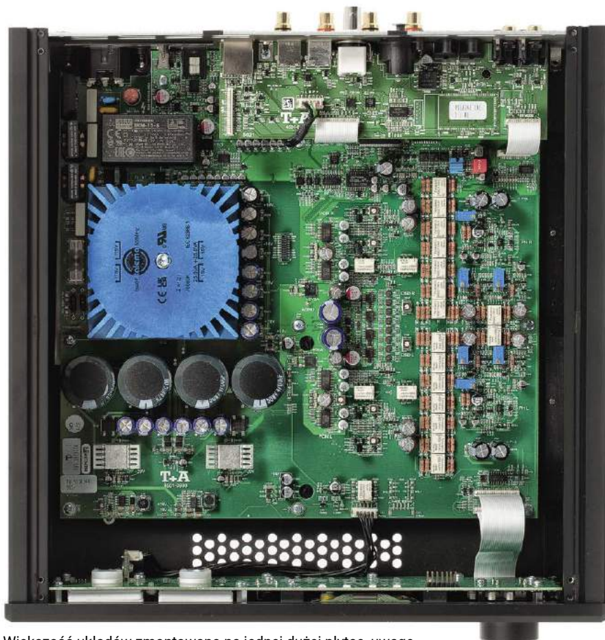
Większość układów zmontowano na jednej dużej płytce, uwagę zwraca duży zasilacz liniowy.
