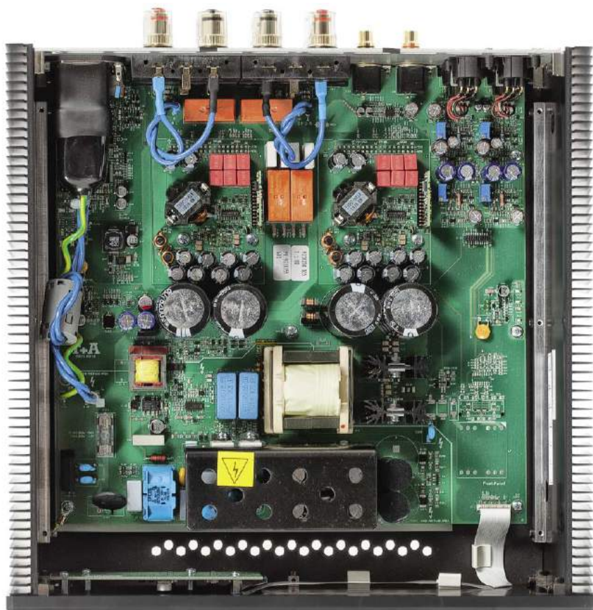
A 200 to klasyczna konstrukcja w klasie D, w pełni analogowa, sygnał jest prowadzony w takiej postaci od wejścia do wyjścia, również modulator w sekcji wyjściowej pracuje w formule analogowej.
