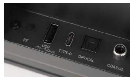
Są też aż dwa złącza USB – jedno dla nośników pamięci, drugie dla opcjonalnego modułu nadajnika dla bezprzewodowych głośników efektywnych.
