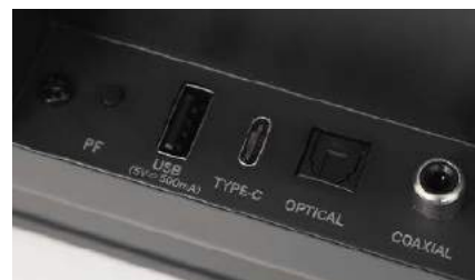
Są też aż dwa złącza USB – jedno dla nośników pamięci, drugie dla opcjonalnego modułu nadajnika dla bezprzewodowych głośników efektywnych.
