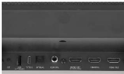
Dwa wejścia HDMI, wejście optyczne i współosiowe. Jak na soundbar – „na bogato”.
