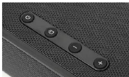
Panel sterujący umieszczono w górnej sekcji listwy. To typowy układ przycisków do regulacji głośności i wyboru wejść.
