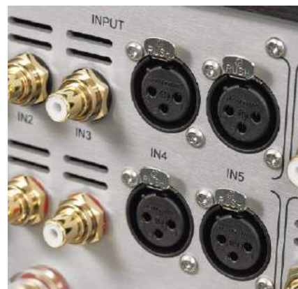
Gniazda XLR pojawiają się też w roli wyjść. W serii FLS dostępna jest końcówka mocy.
