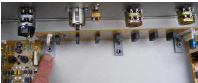
Rysunek 19. Montaż płyty głównej na kątownikach
