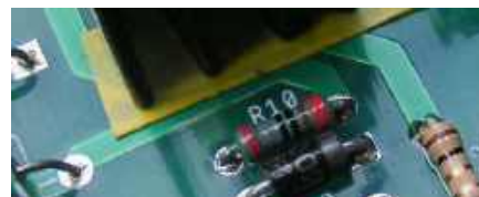
Rysunek 4. Aby odizolować radiator od ścieżek, przyklej pod nim taśmę. Na samą soldermaskę nie można liczyć
