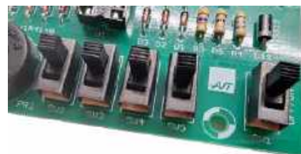
Fotografia 19. Poprawnie zamontowane przełączniki SW1...SW5.
