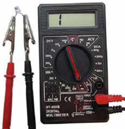
Fotografia 13. Sprawdzanie diody LED za pomocą multimetru ustawionego na testowanie diod. Po przyłożeniu sondy czerwonej do anody, a czarnej do katody sprawna dioda LED powinna się zaświecić. Jeśli dioda ma odpowiednio długie (jeszcze nie przycięte) wyprowadzenia można się wspomóc krokodylkami
