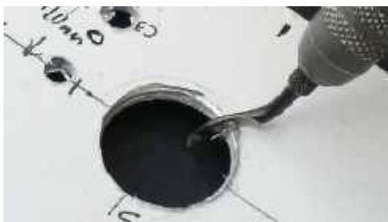
Rysunek 18. W dużych otworach zadziory usuwamy specjalnym narzędziem
