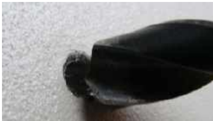
Rysunek 17. Małe otwory można szfazować wiertłem o większej średnicy
