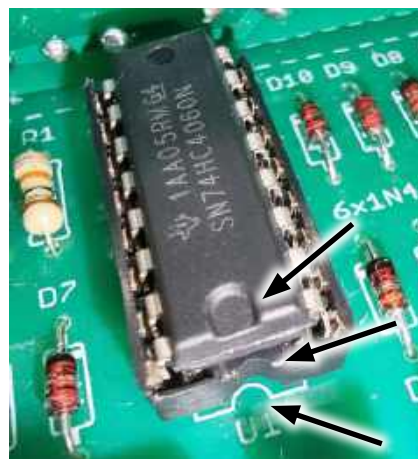
Fotografia 29. Przed zamontowaniem układu scalonego w podstawce należy upewnić się, że znacznik kierunku montażu na płytce, w podstawce i na układzie scalonym znajdują się w tej samej pozycji
