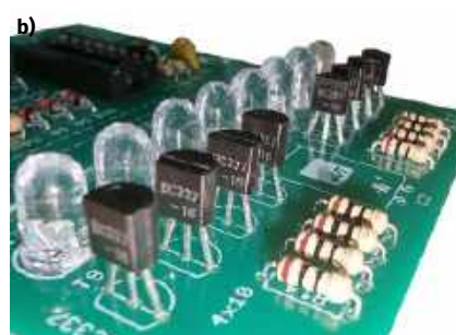
Fotografia 15. Poprawny montaż tranzystorów a) T1 na płytce sterownika oraz b) T2..T9 na płytce z diodami LED. Wszystkie tranzystory są tego samego typu. Korpusy tranzystorów (w kształcie litery „D”) odpowiadają obrysom (również w kształcie litery „D”) na warstwie opisowej płytki PCB
