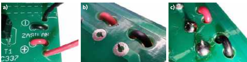
Fotografia 22. Kabelki złącza baterii należy a) przeprowadzić przez otwory pomocnicze od strony komponentów, następnie b) patrząc „od spodu” przełożyć je przez kolejną parę otworów, i na końcu c) przylutować odizolowane i pocynowane wcześniej końcówki kabelków do odpowiednich pól lutowniczych na płytce PCB
