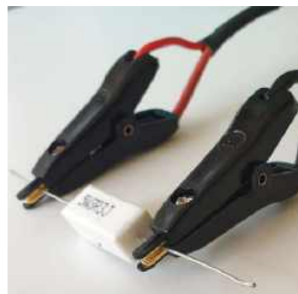
Po lewej: Lokalizacja włącznika/wyłącznika hebelkowy w naszym prototypie Powyżej: Pomiar rezystora ceramicznego 3,3 \Omega
