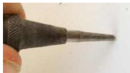
Rysunek 15. Punktak automatyczny. W przypadku wiercenia dużej ilości otworów ta inwestycja bardzo się opłaca
