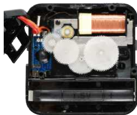
Wnętrze typowego mechanizmu zegara ściennego zmodyfikowanego dla naszego sterownika zegara. Cewka silnika znajduje się w prawym górnym rogu, natomiast niebieska płytka sterująca znajduje się po lewej stronie, z kroplą czarnej żywicy epoksydowej ukrywającej układ sterujący. Został on wyłączony poprzez wycięcie ścieżki PCB, a przewody zostały przylutowane do punktów lutowniczych cewki silnika
