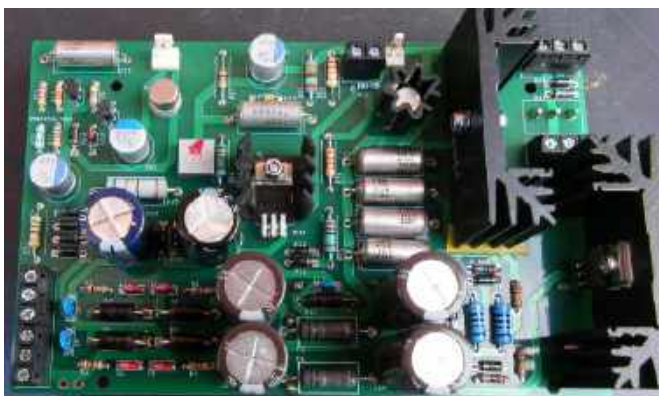
Rysunek 2. Płytkę zasilacza z poprzedniego odcinka w stanie poprawionym. Jest na niej tylko sześć „mokrych” kondensatorów elektrolitycznych Nichicon. Wszystkie pozostałe mniejsze kondensatory spolaryzowane są typu stałego. Zmniejszyło to tętnienia resztkowe w liniach zasilania \pm 15 V o 50%, a w linii zasilania „fantom” o 75%. Oczekiwany czas życia kondensatorów wynosi teraz 40 000 godzin w temperaturze +75^\circ\text{C} . Koszt tej modernizacji wyniósł około 75zł, ale koszt robocizny i przestoju związany z wymianą „mokrego” kondensatora byłby znacznie wyższy
