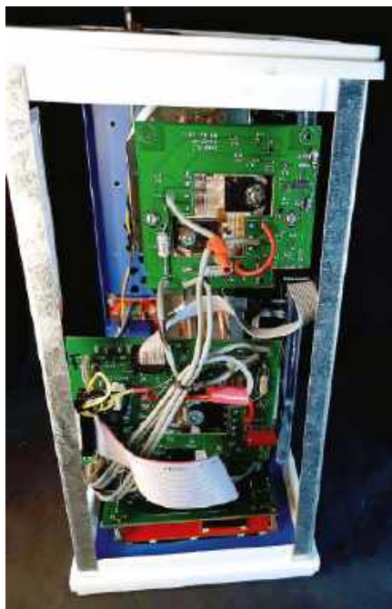
Główne płytki drukowane opisywanego obciążenia są zamontowane na samej górze obudowy
