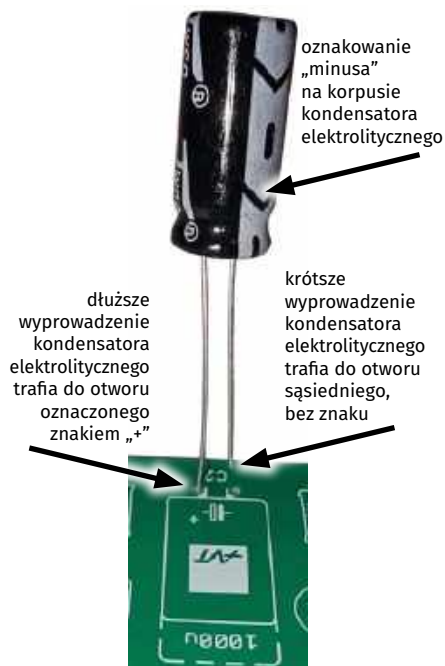
Fotografia 16. Poprawny, zgodny z polaryzacją sposób włożenia kondensatora elektrolitycznego C2 do płytki PCB. Na płytce znakiem „+” oznaczono otwór, w którym należy umieścić dodatnie (dłuższe) wyprowadzenie kondensatora elektrolitycznego a na korpusie (obudowie) kondensatora wyraźnie zaznaczono jego wyprowadzenie ujemne, które jest przy okazji wyprowadzeniem krótszym. Należy je zamontować do sąsiedniego otworu kondensatora elektrolitycznego (bez znaku)
