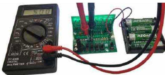
Fotografia 27. Pomiar na zaciskach 16 („plus”) i 8 („minus”) podstawki pod układ scalony wskazał poprawne napięcie baterii (bez znaku „-”, który sugerowałby błędną polaryzację). Można odłączyć zasilanie i zamontować układ scalony w podstawce
