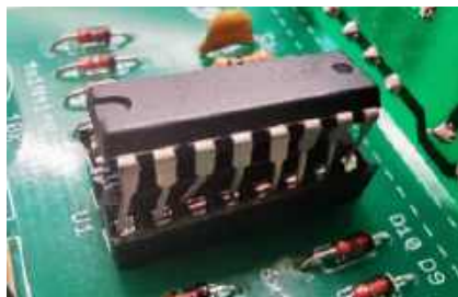
Fotografia 28. Przed wciśnięciem układu scalonego w podstawkę, należy upewnić się, że wszystkie wyprowadzenia układu scalonego trafiły w odpowiednie gniazda, a następnie wzrokowo kontrolować cały proces docisku. W przeciwnym wypadku nóżki układu scalonego mogą zacząć się giąć, a nawet złamać
