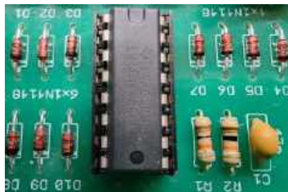
Fotografia 4. Poprawny montaż diod sygnałowych na płytce PCB. Kierunek paska na każdej z diod musi pokrywać się z kierunkiem paska nadrukowanym na płytce PCB
