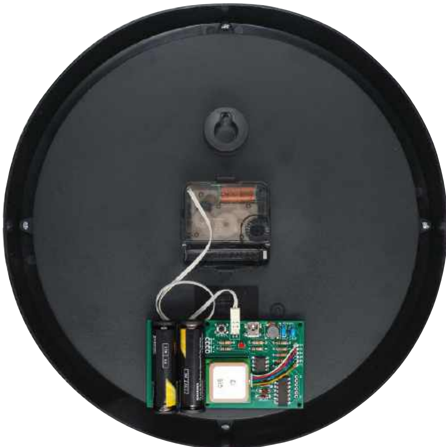
Sterownik zegara GPS umieszczony z tyłu zegara IKEA „TJALLA”. Mechanizm został zmodyfikowany w celu wyprowadzenia połączenia z cewką silnika zegara przez otwór. Płytkę drukowaną sterownika została zaprojektowana tak, aby była mała, ponieważ za zegarem ściennym często jest mało miejsca
