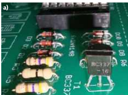
Fotografia 15. Poprawny montaż tranzystorów a) T1 na płytce sterownika oraz b) T2..T9 na płytce z diodami LED. Wszystkie tranzystory są tego samego typu. Korpusy tranzystorów (w kształcie litery „D”) odpowiadają obrysom (również w kształcie litery „D”) na warstwie opisowej płytki PCB
