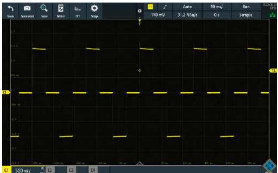
Oscylogram 2. Wyjście sterujące ruchem przemiatającym. Ciągły strumień dodatnich i ujemnych impulsów o częstotliwości 8 Hz. Każdy impuls trwa 31,25 ms i tyle samo, tj. 31,25 ms trwa przerwa między impulsami, co daje 16 impulsów na sekundę. Przy niskim napięciu baterii sterownik zegara wydłuża czas impulsu o 24% i skracza czas bezczynności o tę samą wartość, dostarczając więcej energii do silnika zegara
