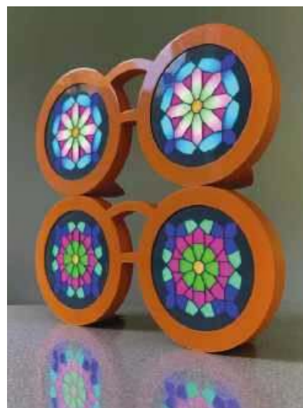
Rysunek 8. Dwa wyświetlacze Owl Glasses z 29-segmentowymi powłokami (góra) i 45-segmentowymi powłokami (dół) (Zdjęcie: Steve Manley)
