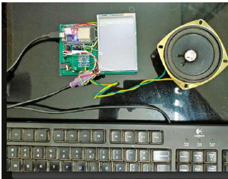
Rysunek 7. Testowanie układu z podłączoną klawiaturą i głośnikiem
