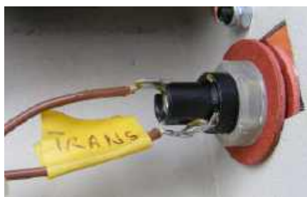
Rysunek 24. Bezpiecznik sieciowy powinien być podłączony za wyłącznikiem zasilania. Pokazany tu bezpiecznik (315 mA, zwłoczny, 20 mm) chroni transformator. Sieć 230 V jest chroniona bezpiecznikiem 3A we wtyczce sieciowej (standard brytyjski – przypis redaktora)
