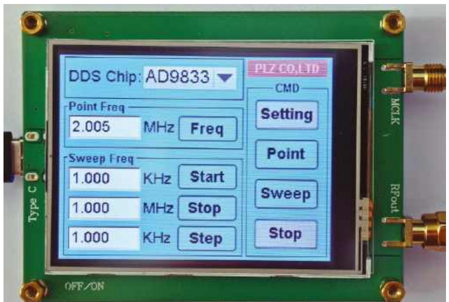
Rysunek 6.15. Programowane źródło przebiegów oparte na układzie AD9833, mogące stanowić podstawę prostych przyrządów pomiarowych jak np. generatory sygnałów, generatory funkcji i wobulatory
