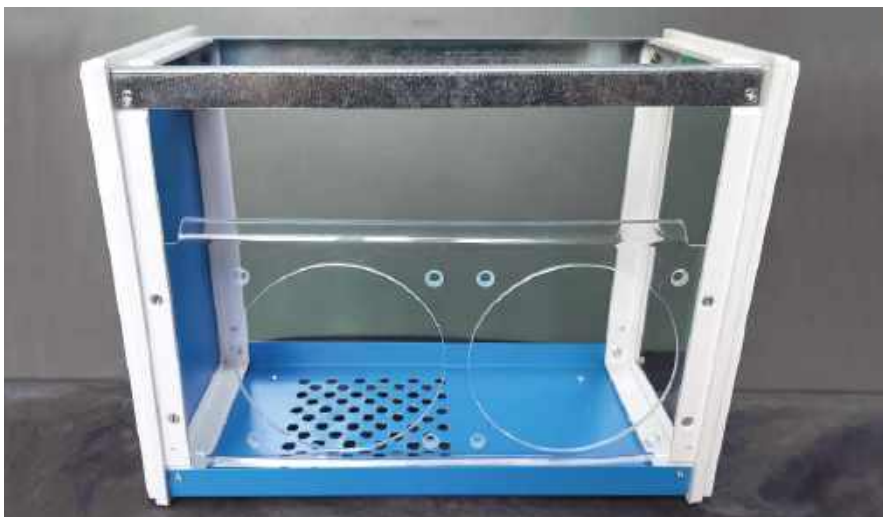
Dla budowanego obciążenia została użyta wentylowana metalowa obudowa o wymiarach 270 mm × 210 mm, jak pokazano na zdjęciu. Do montażu wentylatorów wewnątrz obudowy służy kawałek przezroczystego akrylu o grubości 3 mm. Zagięcia na górze i na dole plastikowego panelu montażowego radiatora mają na celu zwiększenie jego sztywności. Widoczne są również dodatkowe otwory wentylacyjne w podstawie
