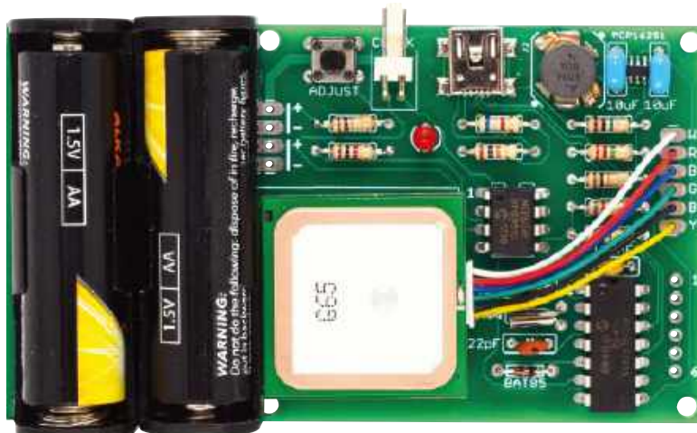
W pełni zmontowana płytka drukowana sterownika. Dotykowy przetątnik do regulacji sekundnika znajduje się w pobliżu górnej krawędzi, obok złącza USB do konfiguracji oprogramowania układowego. W prawym górnym rogu znajduje się cewka i inne elementy związane z przetwornicą, która zapewnia napięcie 4 V dla modułu GPS
