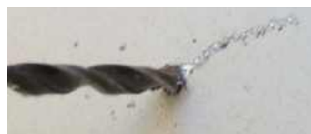
Rysunek 14. „Wędrowki” wiertła można uniknąć, wcześniej punktując otwór
