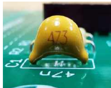
Fotografia 9. Montaż kondensatora stałego C1. Kierunek montażu jest obojętny. Na obudowie kondensatora widać napis „473” informujący o pojemności 47 i 3 zera pikofarów (47000 pF) czyli 47 nF
