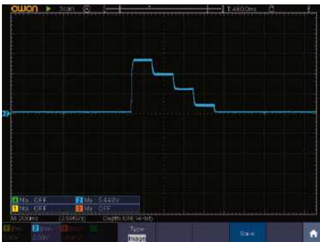
Oscylogram 2: Jest podobny do oscylogramu 1, z wyjątkiem tego, że obciążenie jest zaprogramowane tak, aby szybko wzrosło z 0,5 A do 3 A, a następnie z powrotem do 0,5 A w czterech krokach, ponownie przy użyciu funkcji Step
