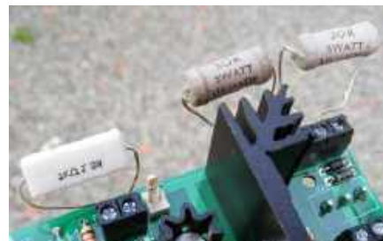
Rysunek 3. Końcowy test zasilacza – obciążenie linii wyjściowych rezystorami drutowymi dużej mocy. Zawsze w ten sposób „wygrzej” zasilacz zanim użyjesz go do normalnego działania. Zawsze wykryjesz uszkodzone elementy lub złe zamocowanie radiatora
