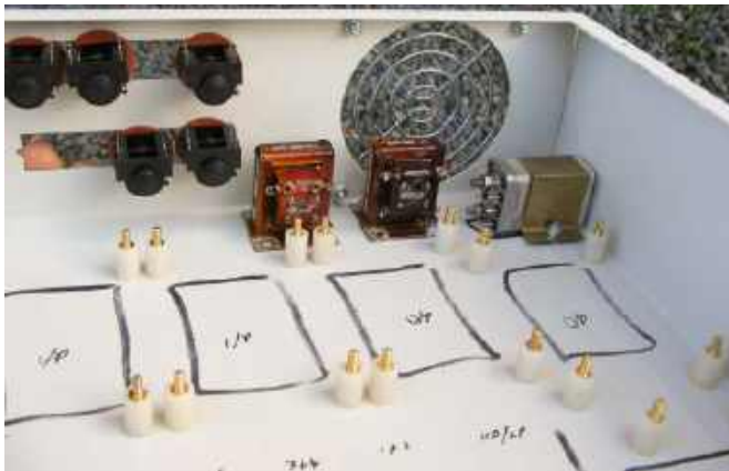
Rysunek 16. Do montażu płytek drukowanych idealne są przykręcane tuleje dystansowe, nylonowe z mosiężnym rdzeniem. Podkładki przyklejane nie trzymają się długo!
