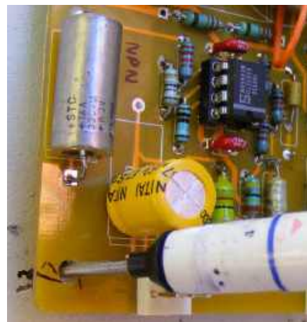
Rysunek 13. Do zaznaczania miejsc na otwory poprzez otwory montażowe w płytkach drukowanych idealny jest pisak stolarski
