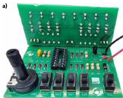
Fotografia 25. Poprawnie zmontowany stroboskop. Widok a) płytki sterującej od strony komponentów oraz płytki wykonawczej od strony lutowania, b) płytki sterującej od strony lutowania oraz c) płytki wykonawczej od strony elementów
