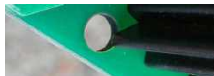
Rysunek 5 (po lewej). Żeby odstąpić otwór montażowy, trzeba spłiwać część żebra radiatora dla IC2. Można też użyć śruby plastikowej lub wywiercić drugi otwór obok
