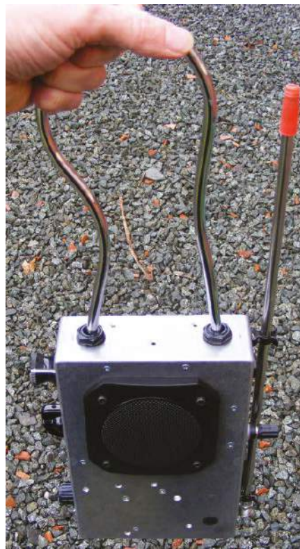
Rysunek 41. Pętla głośności Theremina pełni rolę uchwytu.
