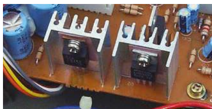
Rysunek 7.4. Dwa trójnóżkowe stabilizatory napięcia wyposażone w radiator montowane na płytce drukowanej.
