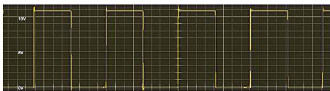
Rysunek 7.14. Przebieg impulsów na pinie 3 układu IC1 (uwaga: jest to prawie symetryczna fala kwadratowa).
