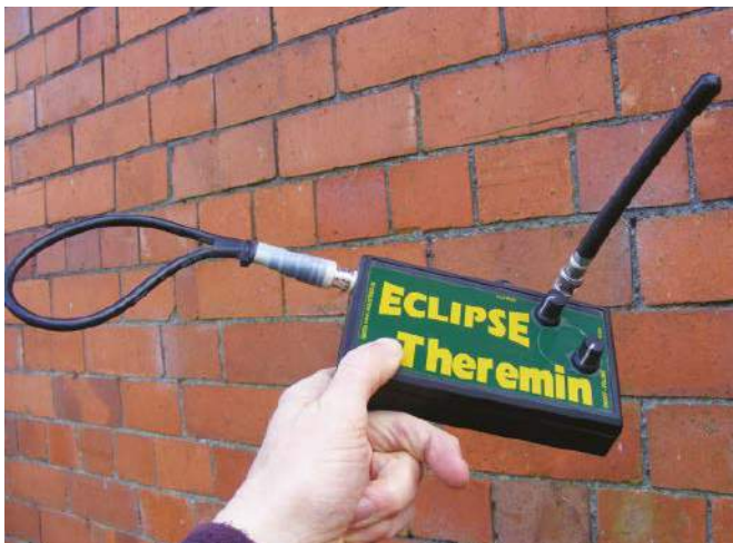
Rysunek 39. Anteny typu „gumowa kaczką” dla przenośnych środków łączności są dobrymi antenami do małych Thereminów. Są one zazwyczaj odłączalne dzięki podstawom z wtykami BNC.
