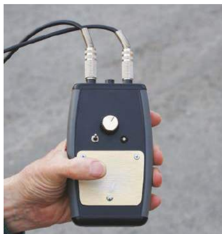
Rysunek 24. Samodzielny sterownik do regulacji głośności oparty na układzie z rysunku 23.
