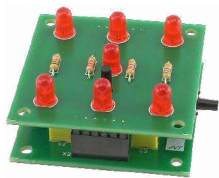
AVT1661 Elektroniczna kostka do gry https://sklep.avt.pl/avt1661.html
