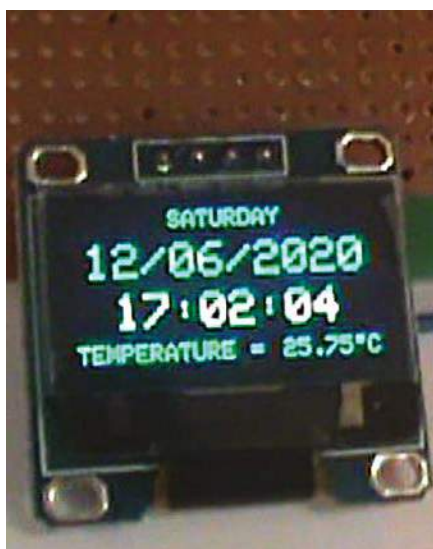
Rysunek 6. Gotowy zegar cyfrowy z wyświetlaniem temperatury
