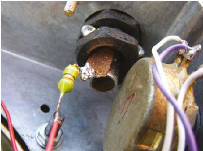
Rysunek 42. Dławiki kablowe to świetny sposób na zamocowanie rurki antenowej. Zwróć uwagę na technikę zaciskania łatwego do lutowania paska miedzianego w dobrym kontakcie elektrycznym z trudną do lutowania chromowaną rurą miedzianą.
