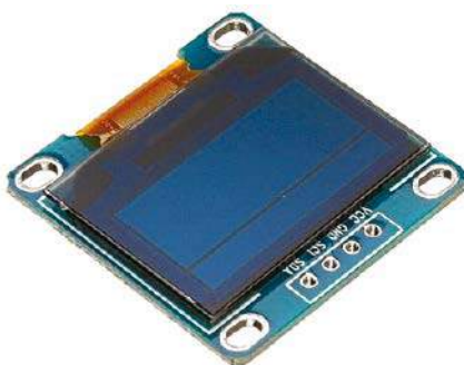
Rysunek 4. Moduł wyświetlacza OLED SSD1306
