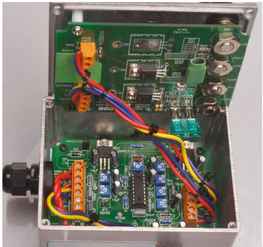
Wnętrze regulatora prędkości obrotowej silnika – kompletne szczegóły budowy zostaną przedstawione w przyszłym miesiącu, ale będą się nieco różnić od tego prototypu. Połączenia na płytce drukowanej MOSFET-ów zostały ustawione do pracy w trybie przełączania po stronie zasilania.
