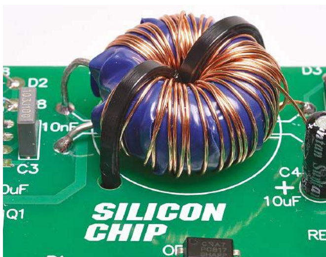
Z powodu braku gotowego transformatora nawinęliśmy własny transformator na bazie gotowej cewki toroidalnej 100 \mu H/5 A. Po zaizolowaniu uzwojenia taśmą nawinęliśmy uzwojenie wtórne o identycznej ilości zwojów jak uzwojenie pierwotne.
