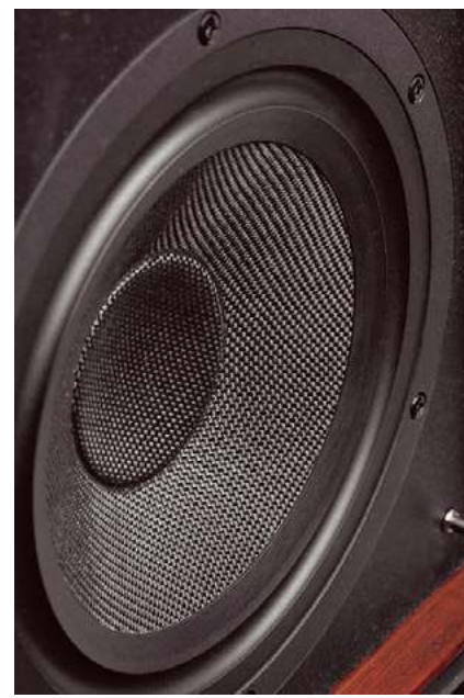
Membrana niskotonowego wydaje się być sztywniejsza nie tylko na skutek zastosowania większej nakładki przeciwpływowej, ale też grubszej warstwy zasadniczej, stożkowej części. Może to być wpływ innego sposobu nasączenia, optymalizowanego w celu uzyskania parametrów właściwych dla danego zakresu częstotliwości.
