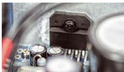
Końcówki mocy złożono z układów scalonych.
