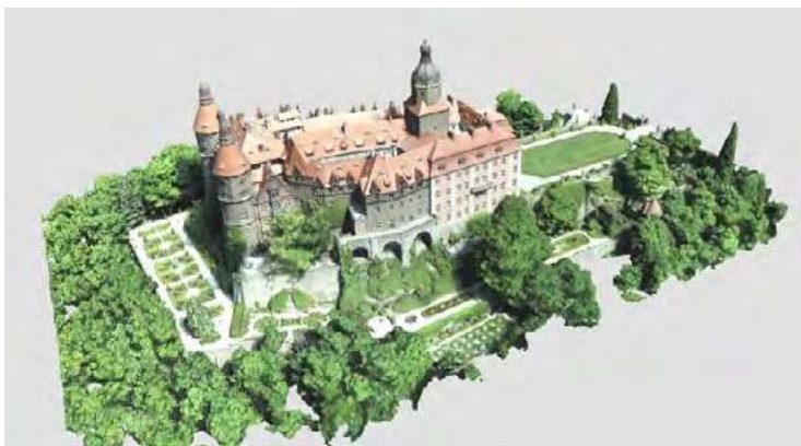
Ryc. 7. Model 3D zamku Książ został stworzony przy użyciu oprogramowania do fotogrametrii
