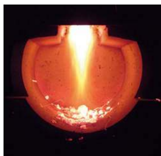
plomień w komorze spalania kotła zgazującego
