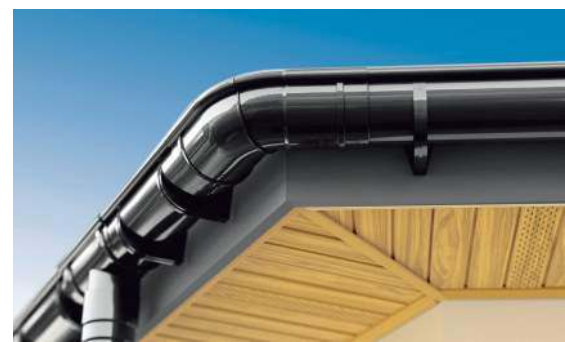
🔑 Korzystanie z narożników rynien z PVC o regulowanym kącie rozwarcia 120–145° ułatwia montaż systemu na nietypowych dachach. Rynien nie trzeba kleić, a narożników zgrzewać. CELLFAST
