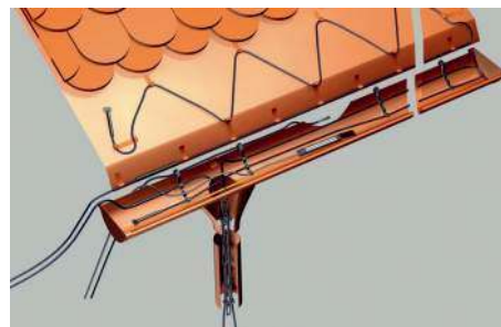
📌 Zarówno rynny, jak i rury spustowe dobrze jest wyposażać w elektryczny system przeciwooblodzeniowy, który podczas mrozów zapobiega gromadzeniu się w nich lodu i śniegu. FENIX POLSKA, ELEKTRA
