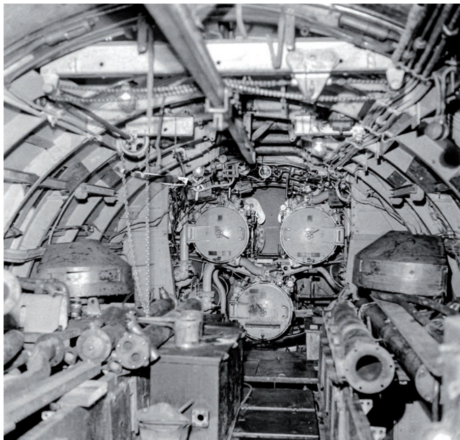
◀ Widok na dziobowe aparaty torpedowe okrętu podwodnego Vesikko (CV-707). Okręt został zaprojektowany i zbudowany dla Niemców w ramach projektu „Liliput”. Jednostka powstała w całkowitej tajemnicy. Po zwodowaniu, szkolenie na okręcie odbywali niemieccy podwodniacy. Ostatecznie w 1936 roku okręt został zakupiony przez Finów od stoczni.
