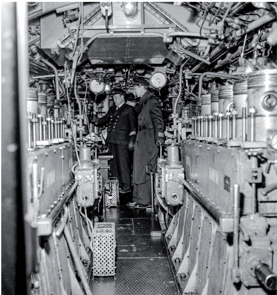
▲ Przedział silników spalinowych na okręcie podwodnym Vetehinen (CV-702). Napęd stanowiły dwa 6-cylindrowe szwedzkie silniki A.B. Atlas o mocy 580 KM każdy przy 515 obr./min. Okręt mógł osiągnąć prędkość 12,5 w. na powierzchni oraz 8,5 w. pod wodą.
