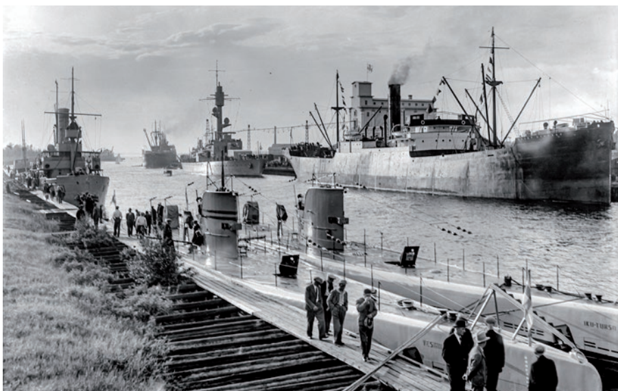
▲ Okręty podwodne Vesihisi (na pierwszym planie) oraz Iku-Turso . Okręty w kamuflażu obowiązującym do marca 1940 roku, polegającym na pomalowaniu kadłubów farbą szarą i czarną. Na kioskach widoczne oznaczenia okrętów w postaci czarnych pasów: dwa dla Vesihisi , jeden dla Vetehinen oraz brak pasa dla Iku-Turso .
