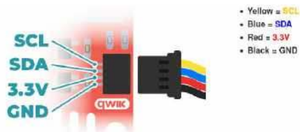
Rysunek 8. Układ wyprowadzeń złącza Qwiic ( http://t.ly/9m6mT )
