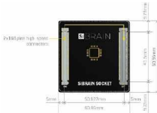
Rysunek 5. Wymiary płytek wg standardu SiBRAIN ( http://t.ly/5oCnh )
