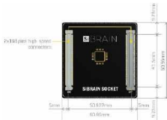
Rysunek 5. Wymiary płytek wg standardu SiBRAIN ( http://t.ly/5oCnh )
