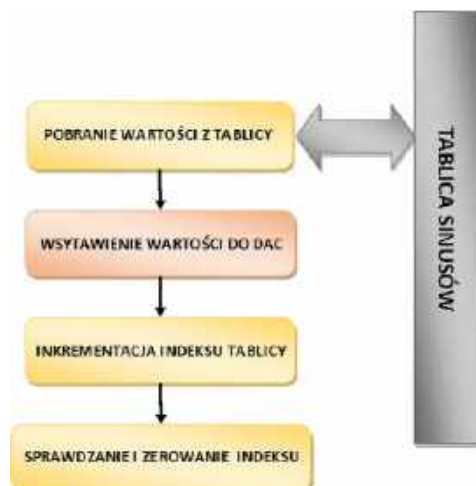
Rysunek 4. Algorytm działania generatora sygnału sinusoidalnego
