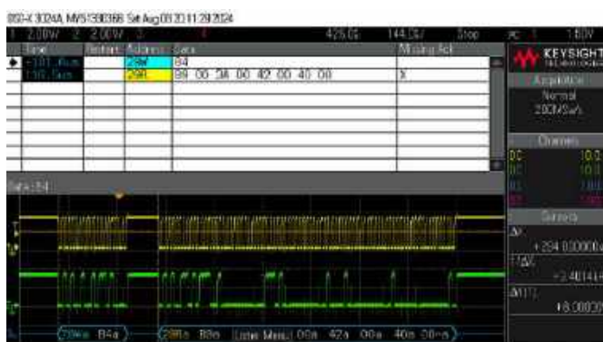
Rysunek 6. Odczyt danych pomiarowych układu TCS3472x
