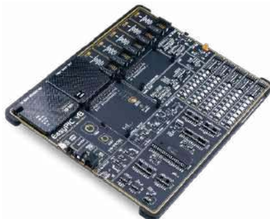
Fotografia 2. Zestaw ewaluacyjny EasyPIC v8 marki MikroElektronika ( http://t.ly/PS3Uv )
