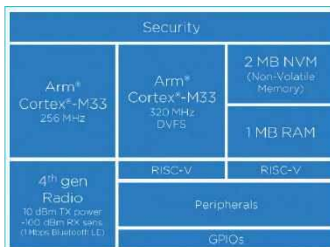
Rysunek 1. SoC nRF54H20 marki Nordic łączy w sobie dwa procesory ARM Cortex-M33 i kilka koprocesorów RISC-V, zoptymalizowanych pod kątem rozmaitych zadań stawianych przed współczesnymi urządzeniami IoT
