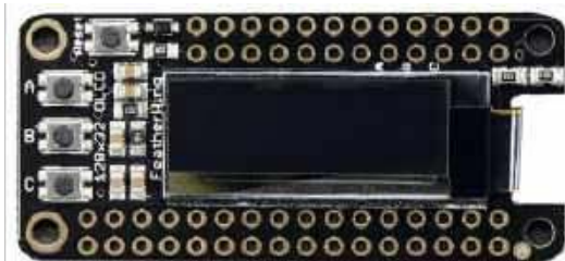
Fotografia 10. Nakładka z ekranem OLED kompatybilna ze standardem Adafruit Feather ( http://t.ly/92U3d )
