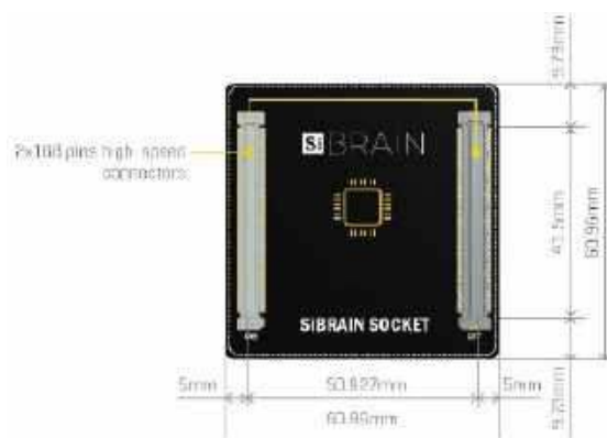
Rysunek 5. Wymiary płytek wg standardu SiBRAIN ( http://t.ly/5oCnh )
