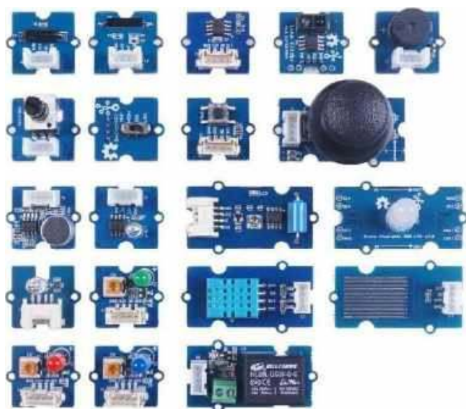
Fotografia 7. Zestaw startowy z dwudziestoma czujnikami Grove ( http://t.ly/2RHzu )
