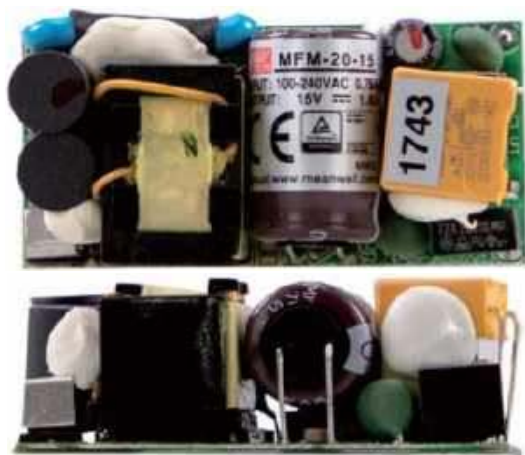
Fotografia 24. Przetwornica AC/DC do druku – MFM-20 marki Mean Well ( http://t.ly/pHTyv )
