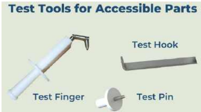
Fotografia 10. Przyrządy probiercze przeznaczone do testowania urządzeń medycznych ( http://t.ly/2cqjX )
