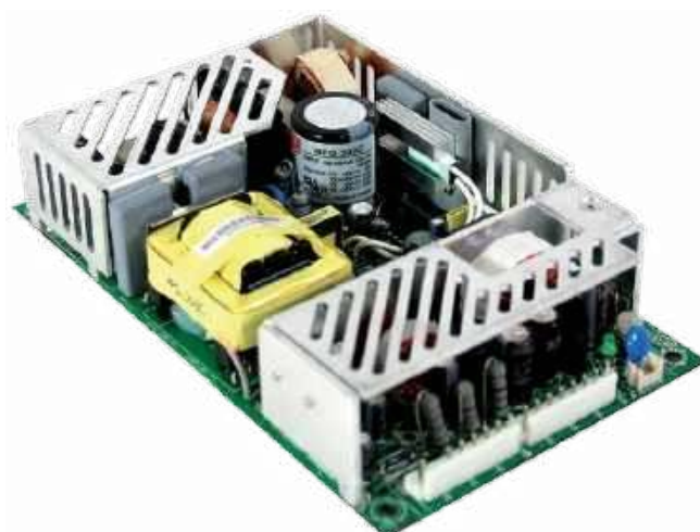
Fotografia 16. Zasilacz z serii MPQ-200 marki Mean Well ( http://t.ly/6NpW8 )
