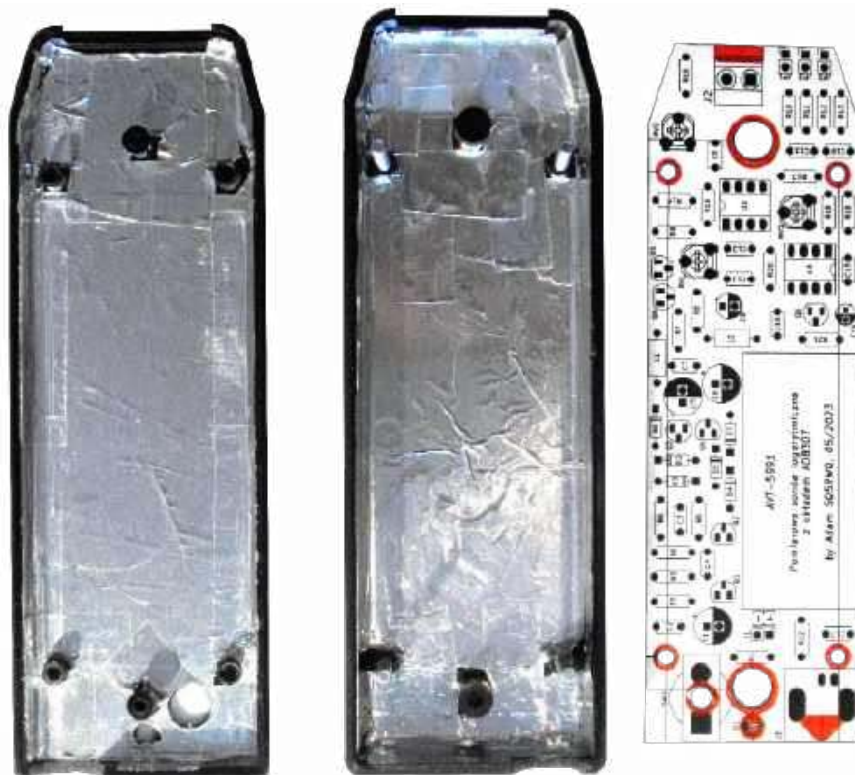
Fotografia 2. Obudowa sondy przygotowana do montażu
