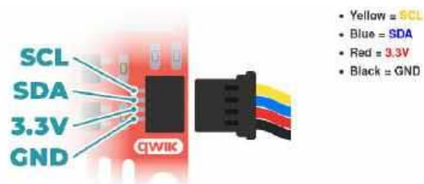
Rysunek 8. Układ wyprowadzeń złącza Qwiic ( http://t.ly/9m6mT )
