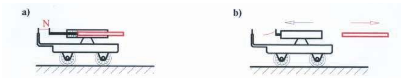
Rys. 4. Eksperyment ilustrujący prawo zachowania pędu. a) wózek przed wystrzałem, b) wózek po wystrzale. Źródło: J. Liwo, B. Porala, Materiały pomocnicze z fizyki. Materiały wewnętrzne WFTiMS PG
