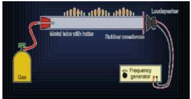
Rys.1 Rura Rubensa. Wydobywające się z rury płomyczki gazu modulowane są przy pomocy zmiany ciśnienia gazu wewnątrz rury przez drgania membrany, która pobudzana jest przez głośnik.
