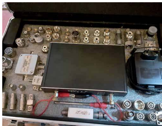
Podręczna walizeczka pomiarowa – jak wygodnie mieć zawsze wszystko pod ręką... Zestaw końcówek i złączy pomiarowych na pasma 50–1296 MHz
