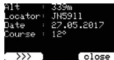
Rys. 4. Ze współrzędnych GPS obliczany jest lokator stacji
