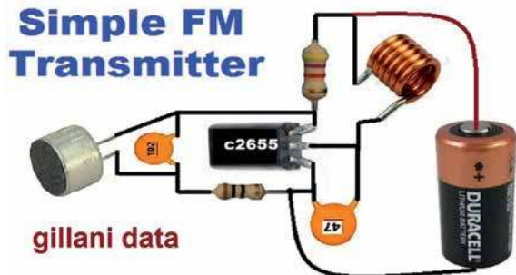
Rys. 3. Schemat montażowy mininadajnika FM
