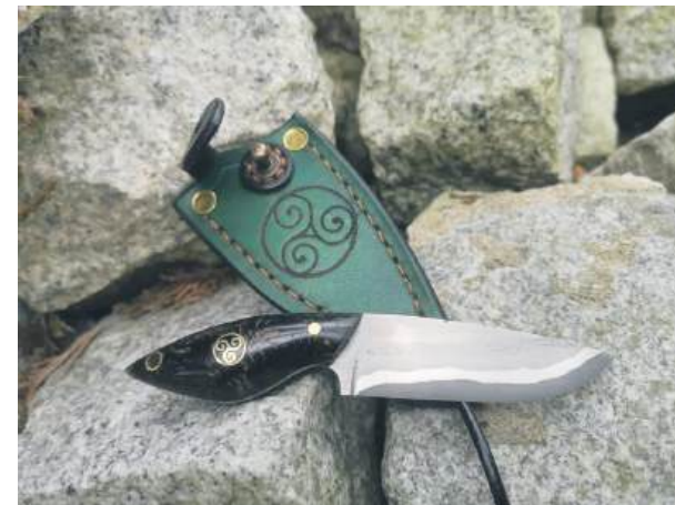
Nóż biżuteryjny typu „neck”. Stal wykonana w technice san mai z rdzeniem węglowym, rękojeść z szyszek olchy w żywicy z akcentem celtyckim wewnątrz pinu oraz na skórzanej pochwie. Fot. Mieszko Górski
