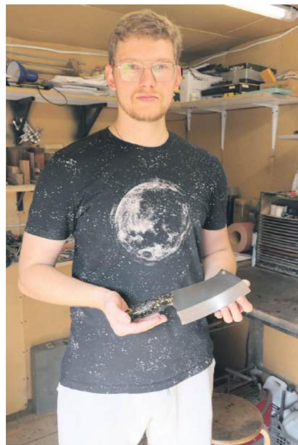
Mieszko Górski prezentuje własnoręcznie wykonany tasak kuchenny do porcjowania mięsa z nierdzewnej stali. Na rękojeści materiał hybrydowy - płatki mosiądzu z włóknem węglowym w żywicy epoksydowej
