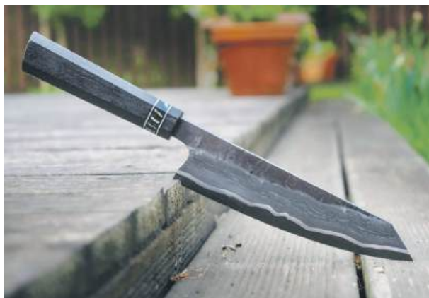
Nóż kuchenny typu Kiritsuke - wykonany przez Mieszka w tradycyjnej technice San-Mai z pięciu warstw stali. Rękojeść ze stabilizowanego drewna czarnego dębu ze wstawką z zęba mamuta. Fot. „By The Wood” Bartosz Winiarski
