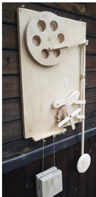
25. Działający model mechanicznego wahadła
