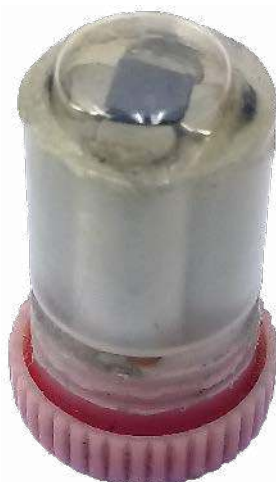
5. Wygląd zewnętrzny przyrządu do pokazu lewitacji diamagnetycznej płytki grafitu pirolitycznego
