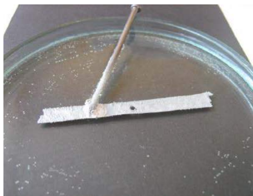
6. Cynk w roztworze NaOH – wodór wydziela się głównie na stalowym gwóźdźu
