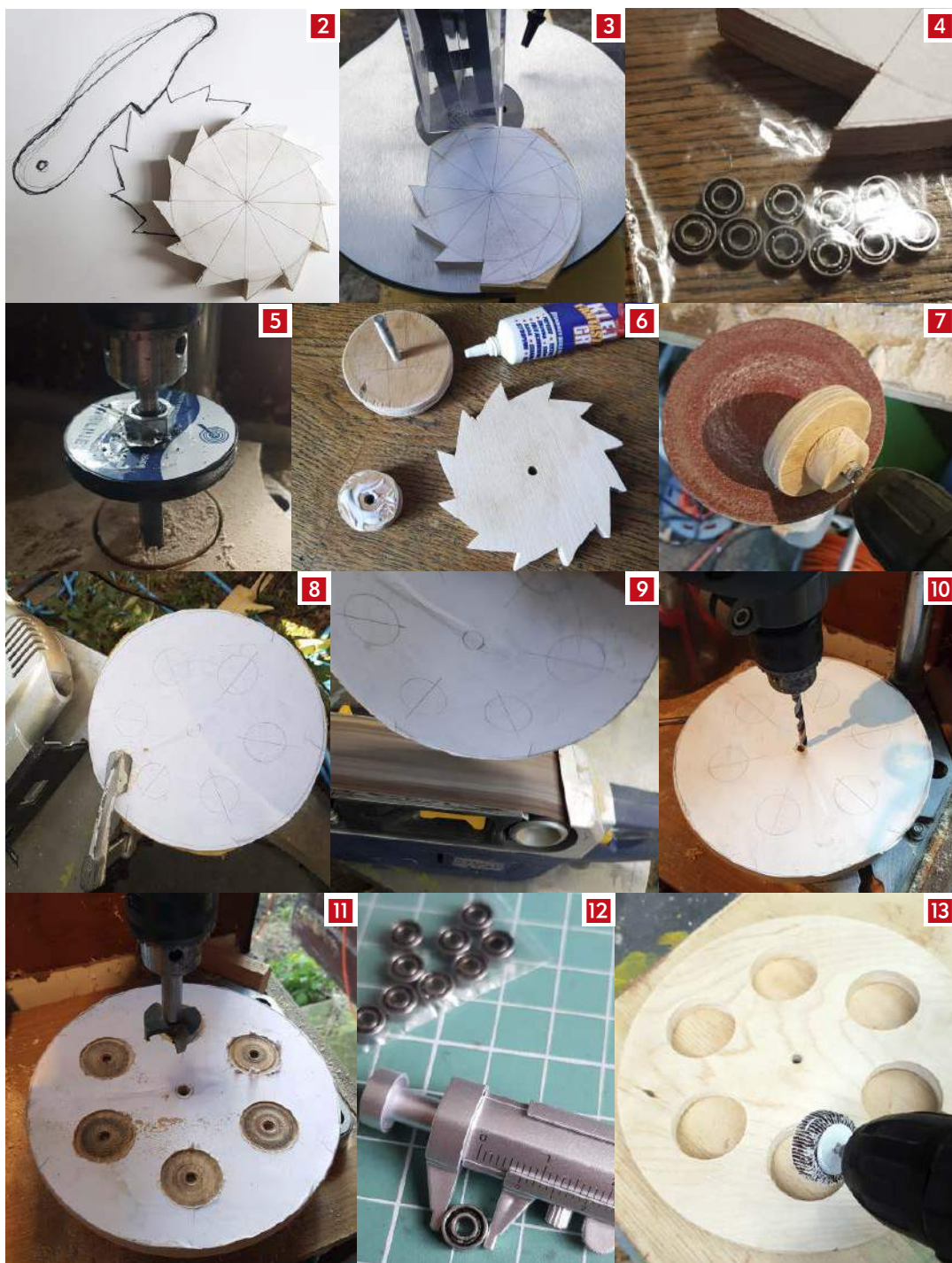
2. Koło zapadkowe i zapadka; 3. Wycinanie zębów koła za pomocą pily włosowej; 4. Małutkie łożyska zapewnią znikome tarcie; 5. Wycinanie krążka ze sklejk; 6. Montaż mechanizmu obciążnika; 7. Tak obrabiamy koła ze sklejk; 8. Koło zamachowe wycinamy wyrzynarką; 9. Zgrubnie obrabiamy koło szlifierką taśmową; 10. Po napunktowaniu wiercimy otwór na oś; 11. Wiercenie otworów 40 milimetrów w kole zamachowym; 12. Łożyska o średnicy 7 milimetrów; 13. Koło zamachowe;
