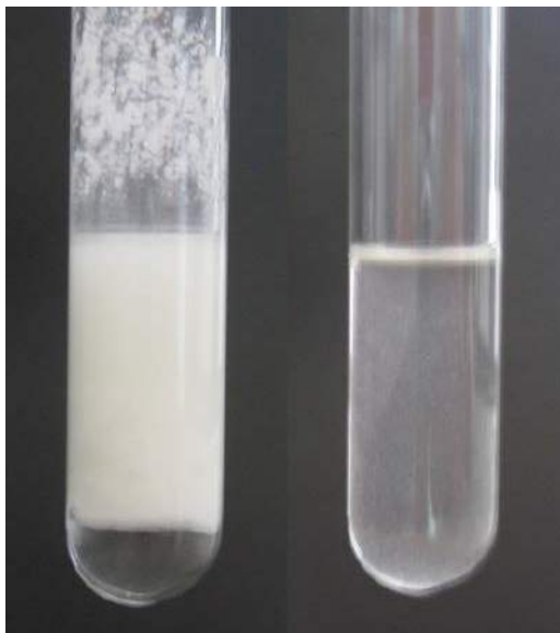
4. Biały osad wodorotlenku cynku (po lewej) jest rozpuszczalny w nadmiarze zasady (po prawej)
