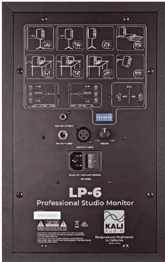
↑ Zespół mikroprełączników na tylnym panelu pozwala dopasować charakterystykę przetwarzania pod kątem umieszczenia monitorów względem ścian, biurka i konsolety, jak też zdefiniować poziom niskich i wysokich tonów oraz czułość wejścia.
