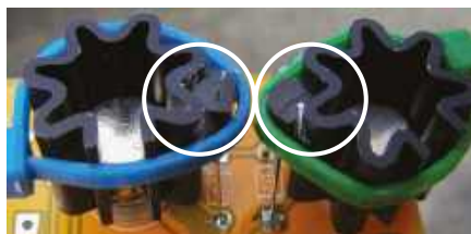
Rysunek 5. Alternatywą dla diod Zenera jest wykorzystanie złącza baza-emiter tranzystorów małosygnałowych – tutaj widzimy je wcisnięte do radiatorów tranzystorów sterujących
