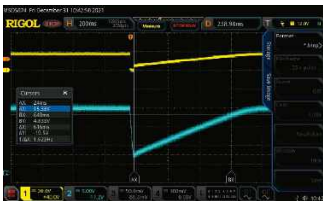
Oscylogram 1. Krzywa napięcia ładowania dla pojedynczego modułu magazynowania energii przy 2 A. Napięcie wzrasta o 10,5 V w ciągu 616 ms. Zwróć również uwagę na widoczną tutaj krzywą rozładowania, którą obliczamy jako 130 A
