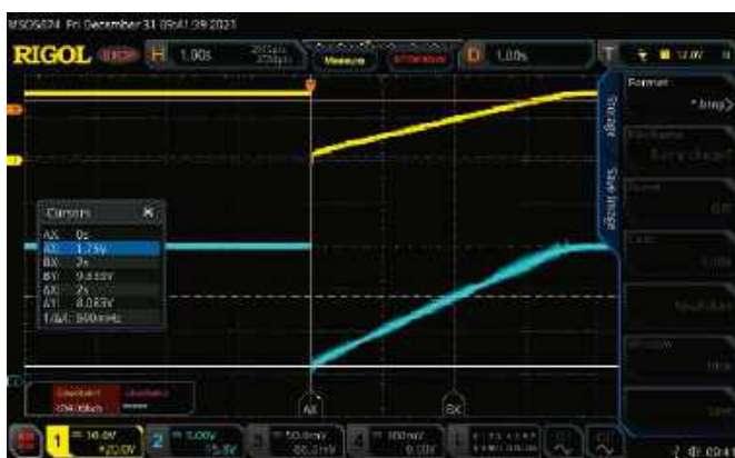
Oscylogram 2. Krzywa napięcia ładowania ze wszystkimi dziesięcioma ESM równolegle. Tym razem prąd ładowania wynosi 5 A, a korzystając ze wzoru podanego w tekście, obliczamy całkowitą pojemność jako minimalnie poniżej 1,2 F
