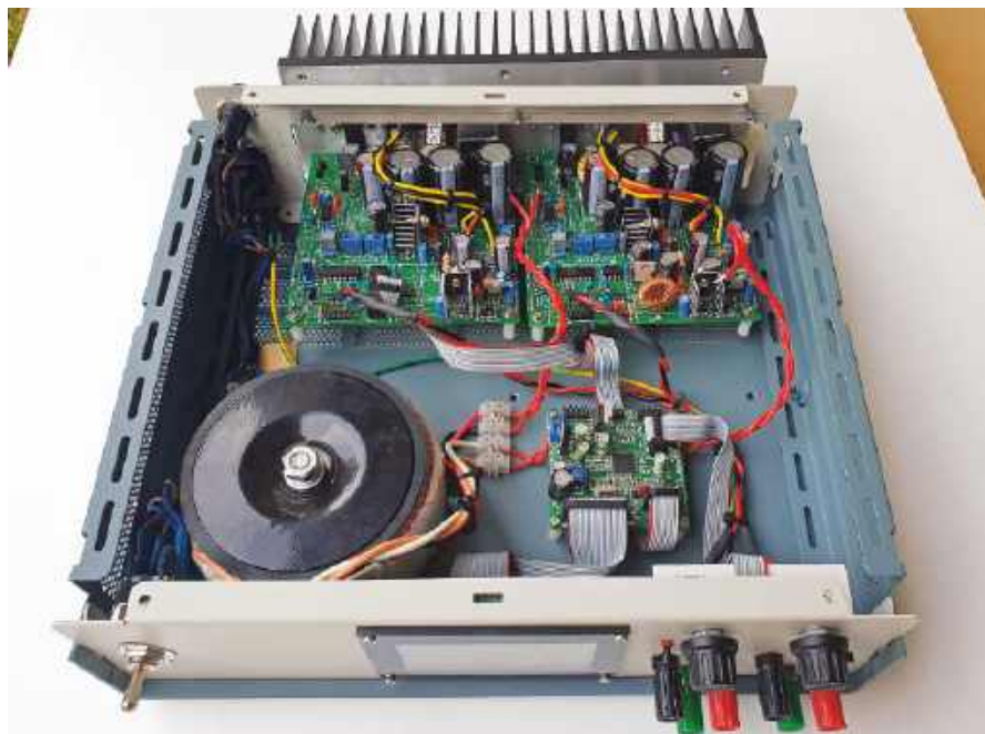
Moduły stabilizatorów zamontowane na radiatorze wsuwają się prosto w obudowę. Na tylnym panelu zostały użyte nakrętki, co pozwala przykręcić radiator bezpośrednio do nich. Dzięki temu rozwiązaniu montaż był dziecinnie prosty
