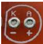
Fotografia 20. Nadruk na warstwie opisowej płytki do zestawu Czerwona świąteczna ozdoba RGB (AVTXMAS3) pokazujący właściwy kierunek montażu diody LED RGB
