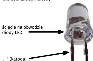
Fotografia 8. Ścięcie na okrągłym obwodzie diody LED lokalizujące katodę
