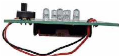
Fotografia 26. Sposób montażu kabelków koszyczka baterii do płytki PCB
