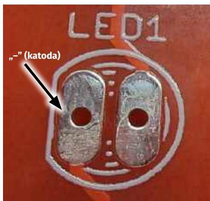
Fotografia 12. Ścięcie okręgu diody musi pokrywać się ze pozycją ścicia na rzeczywistej diodzie LED (fotografia 8) i oznacza katodę. Do tego otworu (ale od przeciwnej strony) montujemy krótsze wyprowadzenie diody LED
