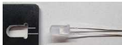
Fotografia 15. Zintegrowana w płytce giętarka do zaginania wyprowadzeń diod LED na określonej i powtarzalną długość. Białe linie wskazują gdzie umieścić dłuższe a gdzie krótsze wyprowadzenie diody LED
