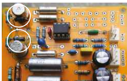
Rysunek 4. Aby zapewnić kompensację termiczną, każda dioda polaryzująca (D1, D2) powinna przylegać do powiązanego z nią tranzystora lub jego radiatora
