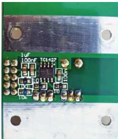
Wszystkie elementy SMD znajdują się na spodzie modułu magazynowania energii (ESM)
