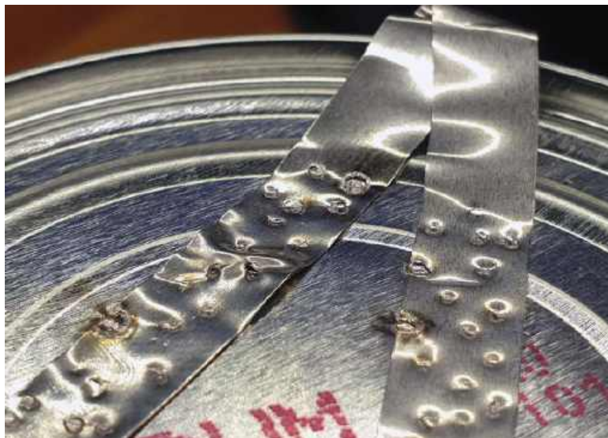
Po zbudowaniu zgrzewarki CD Welder warto wykonać kilka spoin testowych na elementach złomowych. Pozwoli to zorientować się, jakie napięcie i ile czasu potrzeba do utworzenia przyzwoitej spoiny. Zbyt duża energia spali i zniekształci metal, a nawet zrobi w nim dziury, jak pokazano na lewej blaszce. Po prawej stronie widać, że udało nam się przyspawać blaszkę do puszki bez jej zniszczenia
