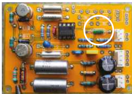
Rysunek 10. Zmontowana płytki wzmacniacza sumującego. Zwraca uwagę zielona cewka (L1), konieczna w przypadku stosowania długiej szyny sumującej
