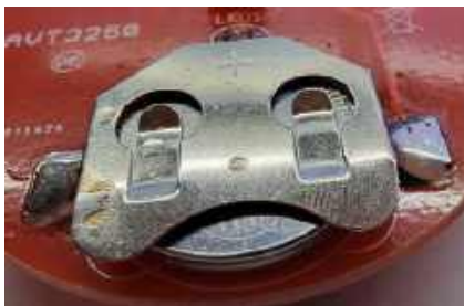
Fotografia 3. Bateria CR2032 zamontowana w słocie tworzonym przez powierzchnię płytki PCB z przylutowaną do niej, dołączoną do zestawu, profilowaną blaszką
