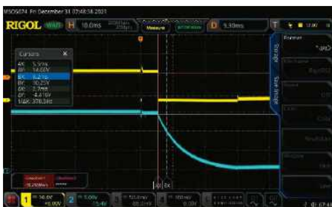
Oscylogram 3. Impuls 200 A do obciążenia. Żółty przebieg to napięcie na wyjściu ujemnym. Niebieski przebieg to napięcie kondensatora, które wykazuje spadek dla początkowego impulsu, a następnie spadek wykładniczy!
