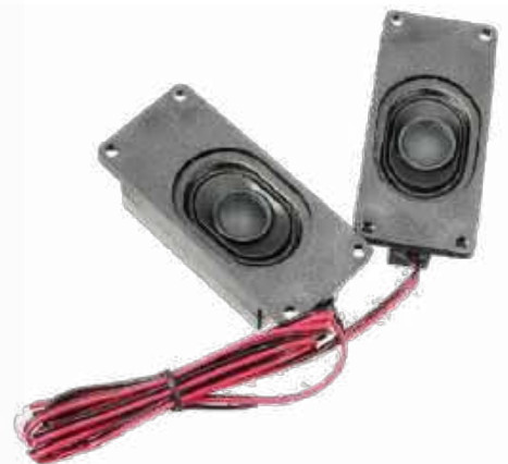
Głośnik 3 W zastosowany w prototypie. Działa bardzo dobrze i można taki polecić, ale istnieje też wiele innych opcji
