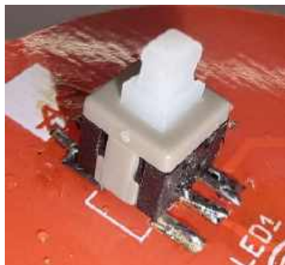
Fotografia 11. Montaż alternatywnego przycisku bistabilnego w miejsce przełącznika dostępnego w zestawie
