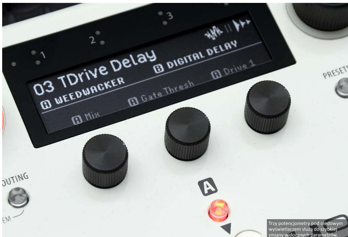
Podświetlane enkodery pozwalają na szybkie poruszanie po Menu, wybór oraz zmianę parametrów.
