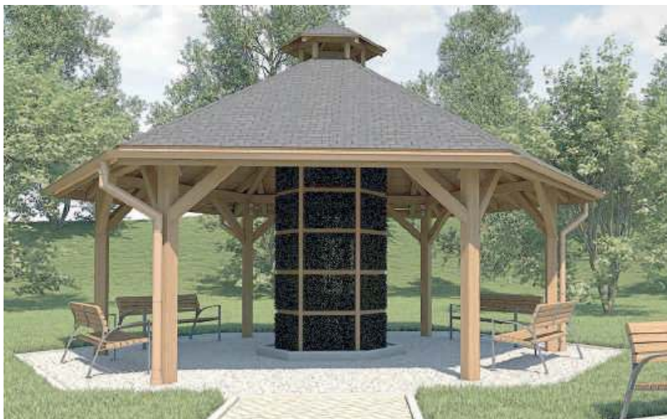
Tężnia to drewniana budowla z gałązkami tarniny lub brzozy, a w środku znajduje się specjalne urządzenie do pompowania słonej wody, które rozprowadza solankę po wiciach, co powoduje wytwarzanie w powietrzu aerozolu bogatego w jod, brom, wapń, magnez, potas, żelazo i sód. To daje mikroklimat wokół tężni podobny jak nad morzem
