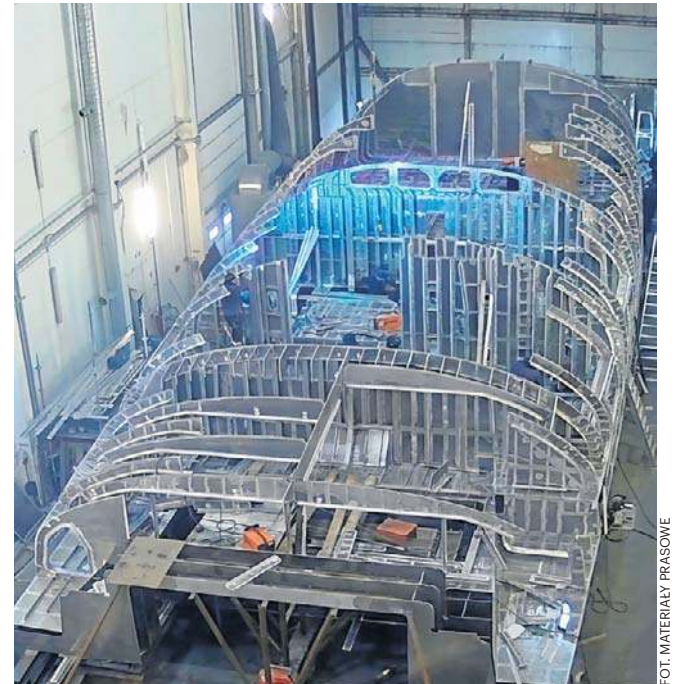
W stoczni budowany jest aluminiowy kadłub
