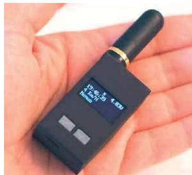
Miniaturowa radiostacja Pico APRS posiada wbudowany modem TNC i odbiornik GPS
