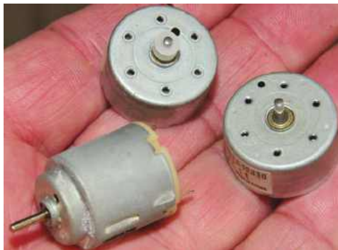
Rysunek 1. Małe, szczotkowe silniki prądu stałego do zastosowań hobbystycznych są łatwo dostępne i niedrogie. Można je również pozyskać ze starych magnetofonów lub zabawek. Silniki te charakteryzują się niskim momentem i dużą prędkością obrotową, więc jeśli nie mają służyć do napędu wentylatora, zazwyczaj muszą współpracować z przekładnią redukcyjną, aby zapewnić użyteczną moc wyjściową
