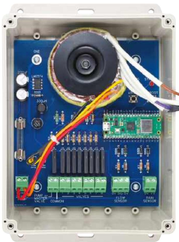
Fotografia 2. Sterownik zamontowany w wodoszczelnej obudowie. Pokazano go z wbudowanym transformatorem sieciowym 24 V, ale należy pamiętać, że musi on zostać podłączony przez wykwalifikowanego elektryka, który prawidłowo podłączy obwód pierwotny do odpowiedniego obwodu zasilania
