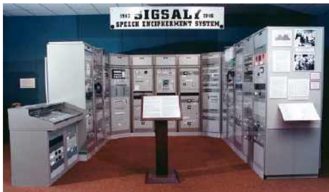
Rysunek 20. Zaawansowany aparat SIGSALY do szyfrowania głosu, używany podczas II wojny światowej. Źródło: https://w.wiki/7DAh
