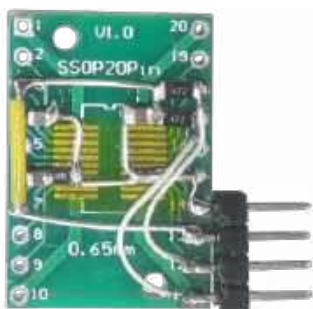
Rysunek 7. Samodzielnie wykonany moduł czujnika, strona tylna
