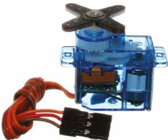
Rysunek 8. Serwomechanizm w wersji mikro. Przez przezroczystą obudowę widać silnik prądu stałego, przekładnię redukcyjną, potencjometr sprzężenia zwrotnego i płytkę drukowaną z układem sterującym (źródło: Wikipedia)
