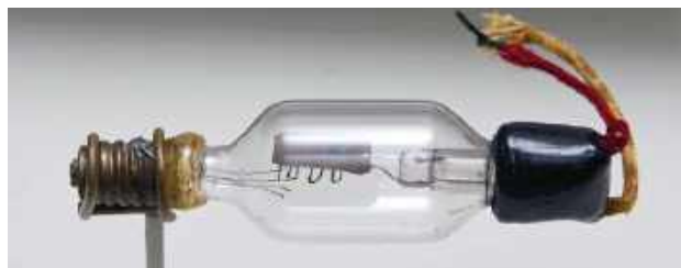
Rysunek 11. Wczesny „Audion” z siatką, wynaleziony w 1906 roku. Wielu uważa tę datę za początek ery elektronicznej. Źródło: https://w.wiki/7DAF (rysunek 11)
