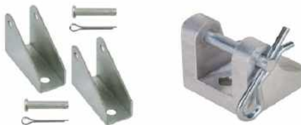
Rysunek 6. Zamocowania siłowników liniowych muszą uwzględniać pewien zakres ruchu obrotowego całego mechanizmu. Zamocowania o małej obciążalności (po lewej) są wykonane z blachy, natomiast zamocowania o dużej obciążalności (po prawej) są odlewane lub wykonane z litego materiału. Sworznie mocujące przechodzą przez otwory wykonane w korpusie siłownika i w wysuwanej części
