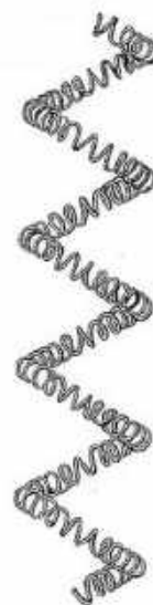
Rysunek 16. Zwinięty w spiralę żarnik lampy wolframowej Burnie'ego Lee Benbowa, opatentowany przez niego w 1917 roku
