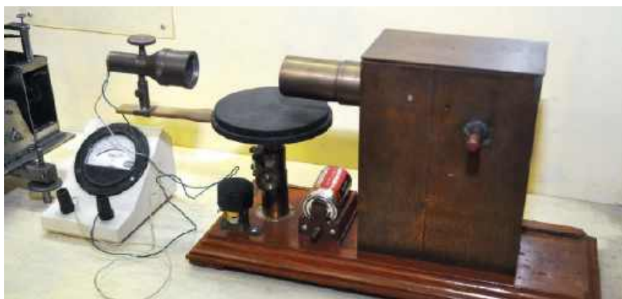
Rysunek 5. Aparatura mikrofalowa 60 GHz autorstwa Jagadisha Bose. Galwanometr i baterię dodano współcześnie. Nadajnik po prawej stronie generuje mikrofałe pochodzące z iskier przeskakujących między kuleczkami metalowymi. Nad galwanometrem, wewnątrz anteny tubowej, umieszczony jest galenowy detektor ostrzowy. Źródło: https://w.wiki/7DAY (CC-SA-3.0)
