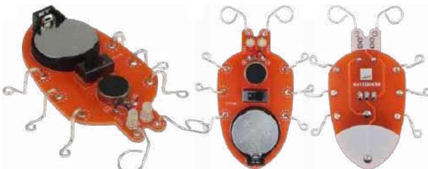
Fotografia 6. AVTEDU658, widoki: a) perspektywa; b) od strony komponentów; c) od strony lutowania
