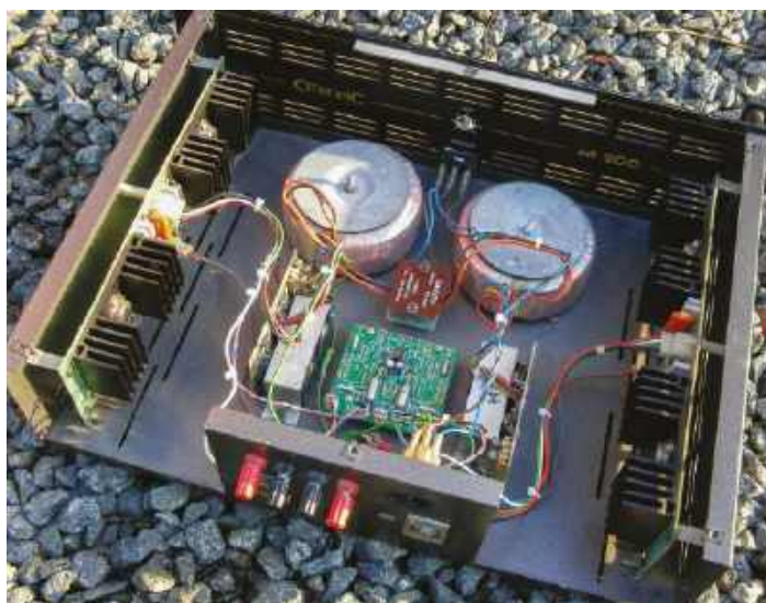
Rysunek 34. Widok zmontowanej płytki zainstalowanej we wzmacniaczu mocy
