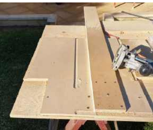
Fotografia 1. Przyrząd zbudowany za pomocą frezarki i kilku ścinków MDF służący do wykonywania precyzyjnie wyrównanych wręg
