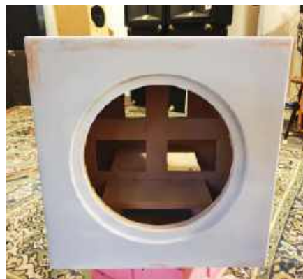
Fotografia 9. Przeszlifowałem i zagruntowałem aktywny subwoofer, a następnie przeszlifowałem go ponownie i dodałem kilka poprawek, aby potężniejsza była idealnie gładkie
