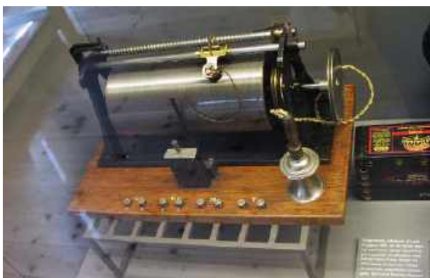
Rysunek 9. Magnetoфон drutowy Valdemara Poulsena, wynaleziony w 1898 roku. Źródło: https://w.wiki/7DAAd (CC-BY-SA-2.5)
