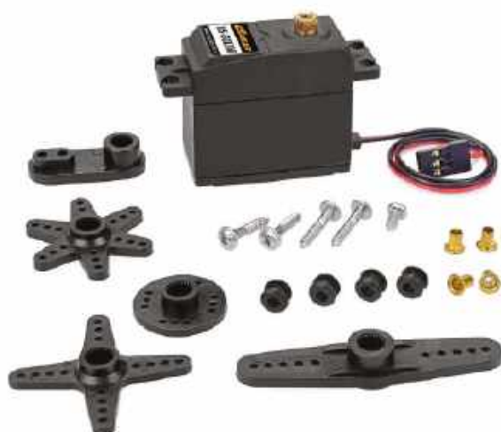
Rysunek 10. Serwomechanizm z typowymi akcesoriami. Na zdjęciu pokazano różne elementy, jakie można przymocować do wału wyjściowego serwomechanizmu, w tym przelotki i kołnierze oraz śruby montażowe. Aby zamontować serwomechanizm w modelu należy wyciąć prostokątny otwór i umieścić w nim cały zespół, a następnie przymocować go z użyciem zaczepów widocznych na zdjęciu
