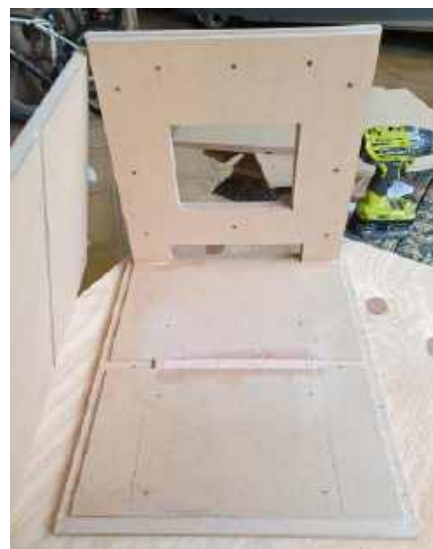
Fotografia 6. Montaż tylnych ścianek. Poprowadziliśmy je prosto w poprzek dolnej ścianki, a następnie wypełniliśmy wręgę w obszarze portu szpachlą do drewna
