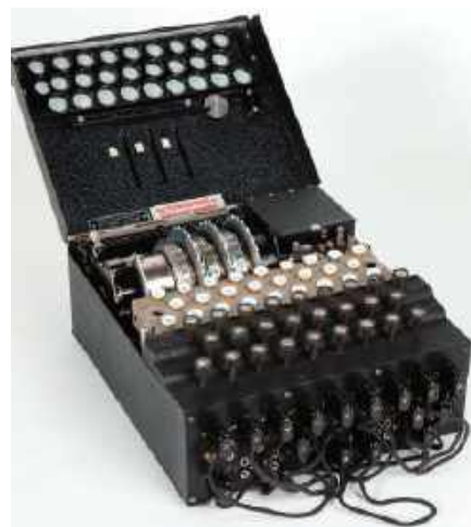
Fotografia 5. Niemiecka maszyna szyfrująca Enigma z czasów II wojny światowej. Jej kod został złamany przez Alana Turinga i innych kryptologów. Źródło: https://w.wiki/7Dwg (CC-BY-SA-4.0).
