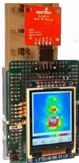
Rysunek 3. Obiekt mierzony z odległości 50 mm, \alpha = 60^\circ
