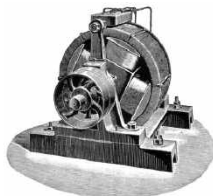
Rysunek 6. Trójfazowy generator Haselwandera z nieruchomą armaturą pierścieniową i czterobiegunowym wirnikiem, zaprezentowany w 1891 roku na Międzynarodowej Wystawie Elektrotechnicznej we Frankfurcie. Źródło: https://w.wiki/7DAZ
