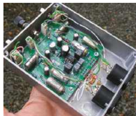
Rysunek 45. Wnętrze zmontowanego przedwzmacniacza z korekcją RIAA zasilany fantomowo
