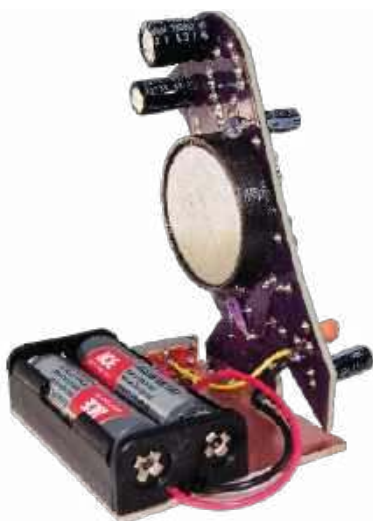
Wersja podstawowa. Główna płytka drukowana jest przylutowana wzdłuż swojej podstawy do kawałka laminatu. Na laminacie jest również zamontowany pojemnik baterii i przełącznik suwakowy
