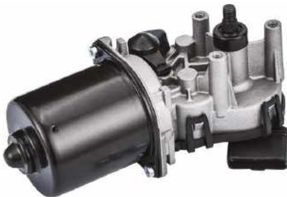
Rysunek 2. Mechanizmy do napędu wycieraczek samochodowych wykorzystują silnik prądu stałego i przekładnię ślimakową o wysokim stopniu redukcji. Zapewniają duży moment obrotowy na wale wyjściowym. Silniki te są dostępne w niskich cenach, zarówno nowe, jak i używane
