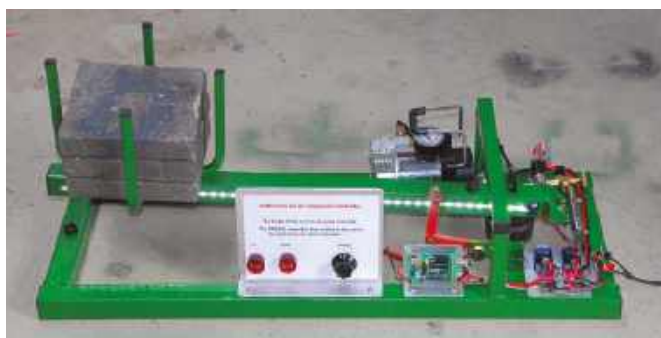
Rysunek 7. Model który sam skonstruowałem ma wyjaśniać działanie systemu sterującego wysokością zawieszenia pneumatycznego w samochodzie. Kompresor (widoczny z tyłu) dostarcza sprężone powietrze do siłownika pneumatycznego (czarny cylinder) przez zawór elektromagnetyczny. Siłownik porusza dzwignią obciążoną kostką brukową (widoczną po lewej stronie). Informacje dotyczące położenia dzwigni są wytwarzane przez potencjometr połączony mechanicznie za pomocą łożysk (czerwone ramiona). Po usunięciu kostki obciążającej dzwignię jej ramie unosi się do góry a sterownik powoduje zmniejszenie ciśnienia w siłowniku pneumatycznym, tak by utrzymać to samo ustawienie. Pokrętło dostępne na płycie przedniej pozwala zmieniać ustawienie dzwigni poprzez zmianę ciśnienia powietrza w siłowniku. W takim systemie informacje zwrotne dotyczące położenia dzwigni mają kluczowe znaczenie
