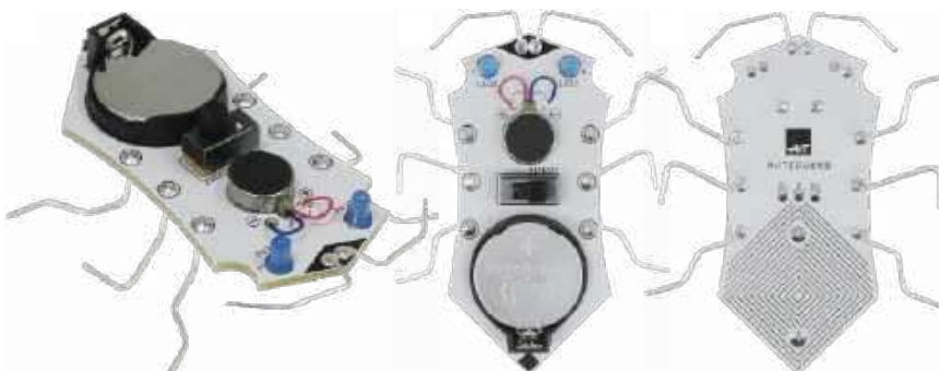
Fotografia 7. AVTEDU659, widoki: a) perspektywa; b) od strony komponentów; c) od strony lutowania
