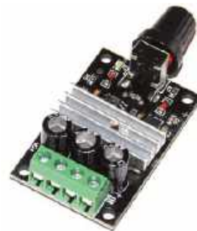
Rysunek 3. Przykładowy moduł do sterowania prędkością obrotową silnika prądu stałego. Działa na zasadzie regulacji współczynnika wypełnienia impulsów napięcia wyjściowego. Ma obciążalność 3 A, kosztuje poniżej 2 funtów. Działa przy napięciu wejściowym od 6 do 28 V, a prędkość obrotową można regulować za pomocą pokrętki. Te sterowniki są łatwo dostępne w handlu
