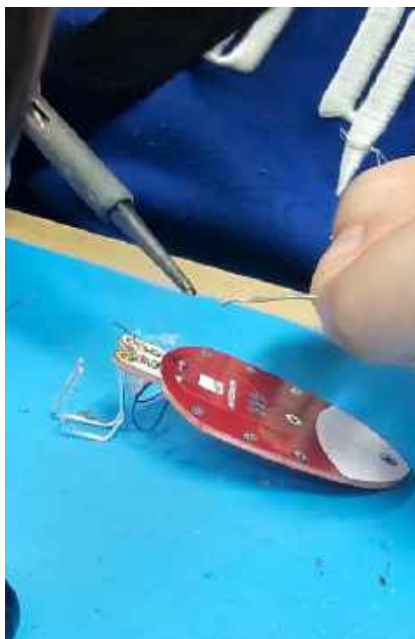
Fotografia 9. Lutowanie kabelków silniczka do płytki
