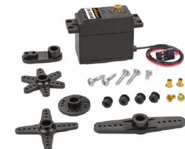
Rysunek 10. Serwomechanizm z typowymi akcesoriami. Na zdjęciu pokazano różne elementy, jakie można przymocować do wału wyjściowego serwomechanizmu, w tym przelotki i kołnierze oraz śruby montażowe. Aby zamontować serwomechanizm w modelu należy wyciąć prostokątny otwór i umieścić w nim cały zespół, a następnie przymocować go z użyciem zaczepów widocznych na zdjęciu
