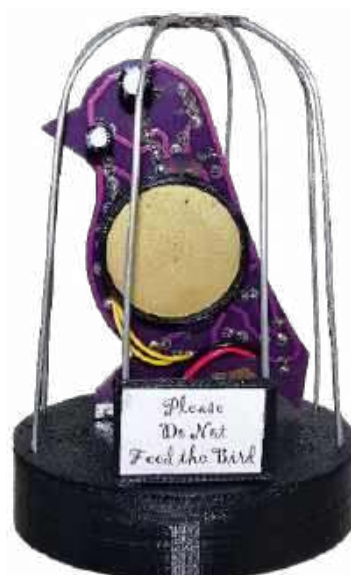
Wariant „klatka dla ptaków” zawiera podstawę wydrukowaną w 3D i kilka drutów pełniących rolę prętów klatki. Głośnik jest przymocowany do tylnej części płytki drukowanej obejmą z rysunku 9
