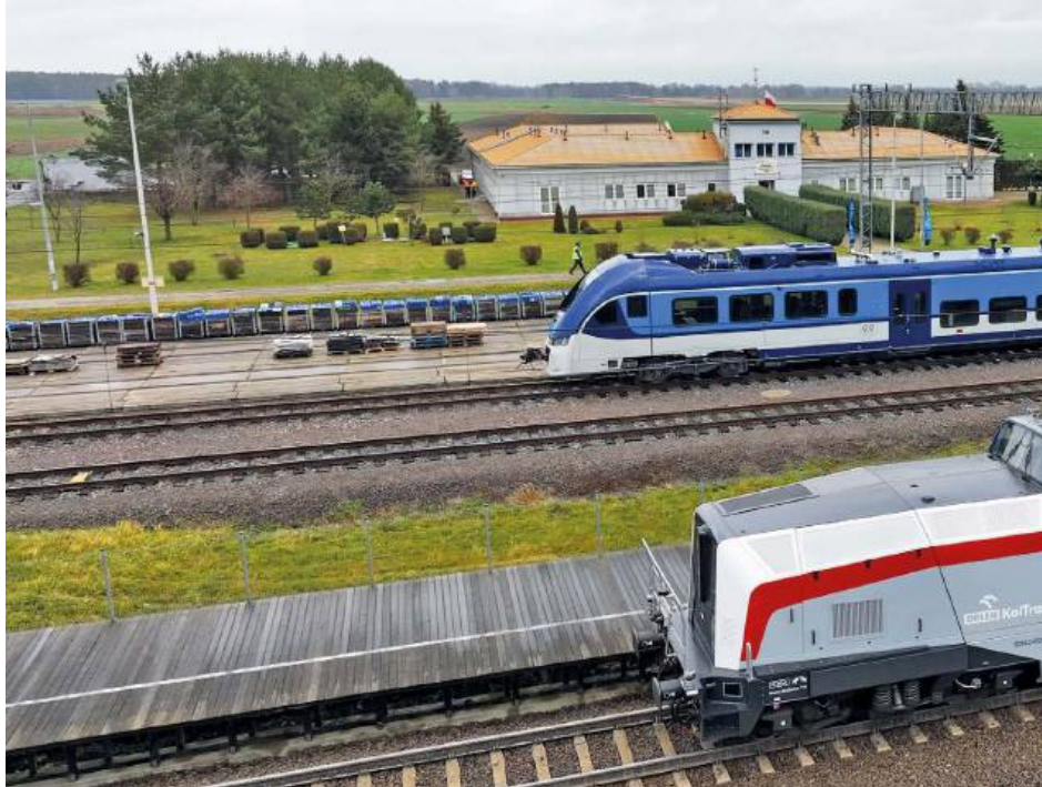
SM42-6Dn wyprodukowana przez spółkę Pesa to pierwsza na rynku europejskim lokomotywa wodorowa, która została dopuszczona do eksploatacji
