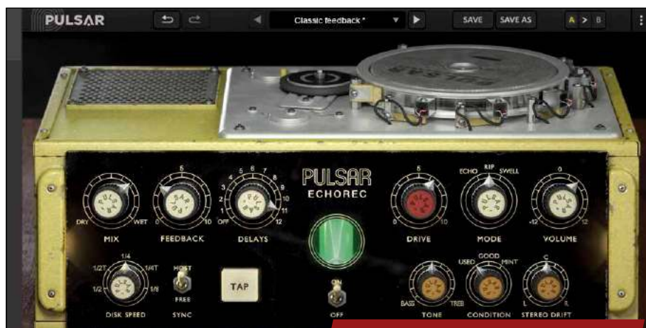
Pulsar EchoRec modeluje wariant delaya taśmowego, w którym zamiast zapętlonej taśmy wykorzystano obracający się dysk.
