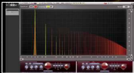
Widoczne w analizatorze widma harmoniczne generowane przy delikatnym nasyceniu (zielony) i głębokim zniekształceniu (czerwony).
