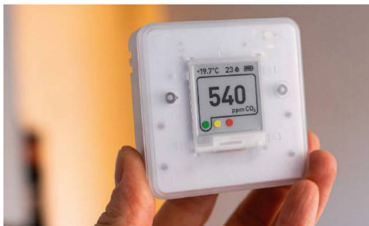
Czujnik dwutlenku węgla, którego poziom jest wskaźnikiem skuteczności wentylacji.
