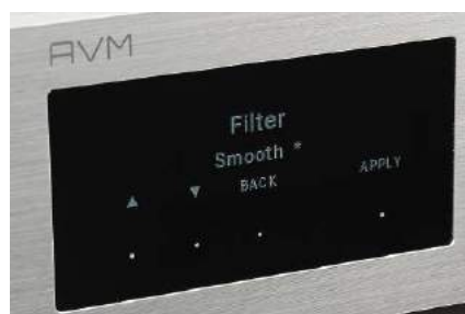
Przetwornik C/A ESS Technology pozwala na wybór kilku trybów filtrów cyfrowych.
