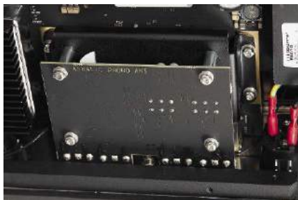
Moduł phono umieszczono na niezależnej płytce, pod którą widać dodatkowy ekran.
