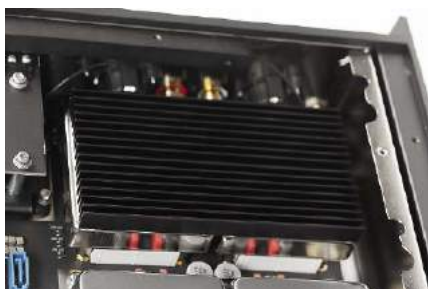
W tylnej części widać moduły wyjściowe (analogowe) w klasie A chłodzone radiatorem.
