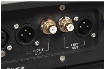
Regulacja głośności jest analogowa i symetryczna, co współgra z wyjściami XLR.
