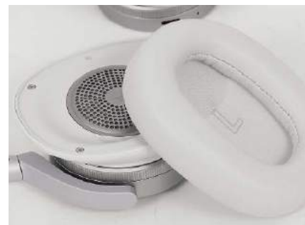
Pady można zdjąć i wymienić, są mocowane systemem magnesów.
