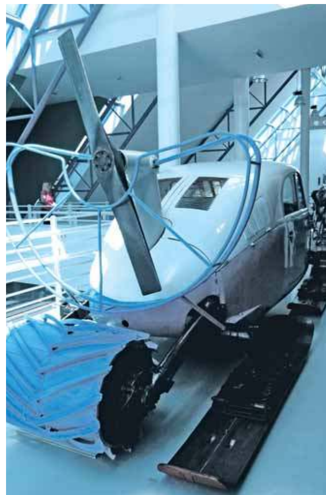
Prototyp skuteru z 1942 r. Tym skuterem śnieżnym sterowano za pomocą dwóch par nart i kierownicy. Napęd generowało śmigło pchające i mechaniczny bęben z wałem napędowym. Bęben pełnił również funkcję hamulca. Hamulce ręczne były zamontowane na tylnych nartach
