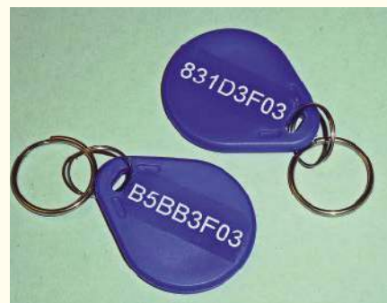
Rysunek 2.11. Tagi RFID oznaczone unikalnymi 64-bitowymi identyfikatorami
