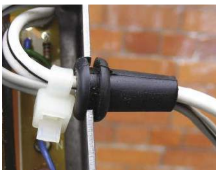
Rysunek 21. Kabel wyjściowy zasilacza prądu stałego to często dwużyłowy kabel o zaznaczonej polaryzacji (o przekroju przypominającym ósemkę), zwykle tani kabel głośnikowy. Zwróć uwagę na gumową przelotkę
