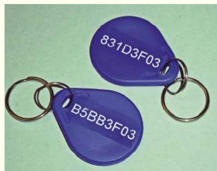
Rysunek 2.11. Tagi RFID oznaczone unikalnymi 64-bitowymi identyfikatorami
