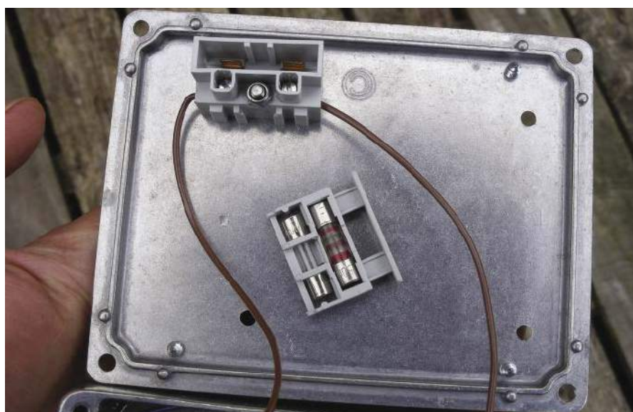
Rysunek 19. Odpowiedni wewnętrzny uchwyt bezpiecznika – jest izolowany, więc nie można ulec porażeniu. Musi być umieszczony w przewodzie fazowym (L)
