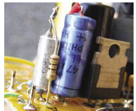
Rysunek 30. Niebieski kondensator to kondensator typu SAL, ze stałym elektrolitem z \text{MnO}_2 . Kondensator wyjściowy C12, firmy Philips, ma on stosunkowo wysoki i stały ESR, co daje stabilną reakcję w odpowiedzi na zmieniające się obciążenia. Kondensator tantalowy w metalowej obudowie w kolorze srebrnym ma rezystor dodany szeregowo, który zwiększa niezawodność. (Zwróć uwagę, że to zdjęcie pokazuje zasilacz -9 V, z uziemionym plusem – zostanie opisany w przyszłym miesiącu)
