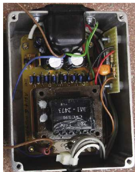
Rysunek 32. Wnętrze zasilacza – mała płytka z boku to Zobel – „zwarowany układ” z części 1
