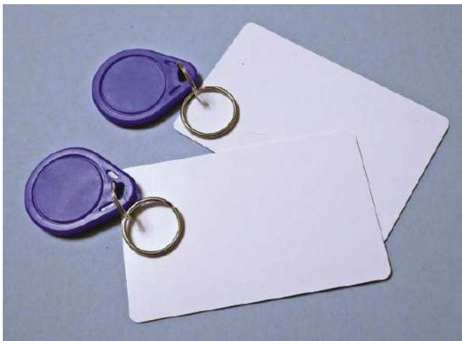
Rysunek 2.1. Powszechnie dostępne tagi RFID (po lewej) i karty (po prawej)
