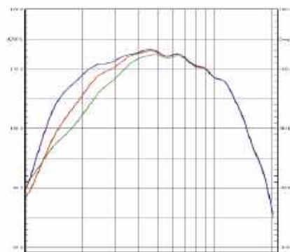
Rys. 1. Charakterystyki dla trzech profili najniższych częstotliwości (THX, duże pomieszczenie, małe pomieszczenie).
