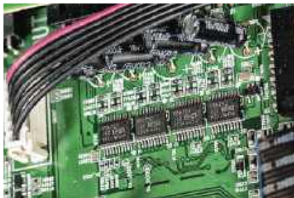
Sekcja C/A jest zespołem dwukanałowych skalaków firmy Burr Brown.
