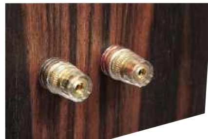
Trochę niepasująca do szlachetności LS3/5A jest jakość terminali przyłączeniowych – to popularne, tanie elementy. Przydałoby się coś „ekstra”.
