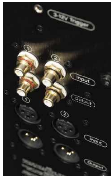
Sygnał dostarczamy do wejść RCA lub XLR. Są też wyjścia w obydwu standardach, które pozwalają „łańcuchowo” podłączyć kolejne subwoofery. Z tyłu nie ma żadnych klasycznych manipulatorów, po podłączeniu nie będziemy tam zaglądać.
