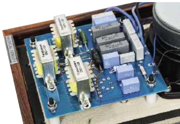
Schemat, wartości, aranżacja, a nawet rodzaj niektórych elementów (cewki „transformatorowe”) jest taki jak w pierwszych LS3/5A; cewka na pierwszym planie jest jednocześnie elementem górnoprzepustowego filtra 3. rzędu i autotransformatorem dopasowującym poziom (tłumienie do konkretnego egzemplarza przetwornika wysokotonowego), stąd tak wiele wyprowadzeń.
