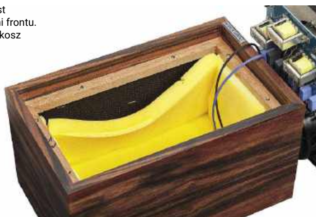
Tak jak pół wieku temu, obudowa jest wykonana z 12 mm sklejki brzoazowej, wytłumiona matami bitumicznymi i gąbką.
