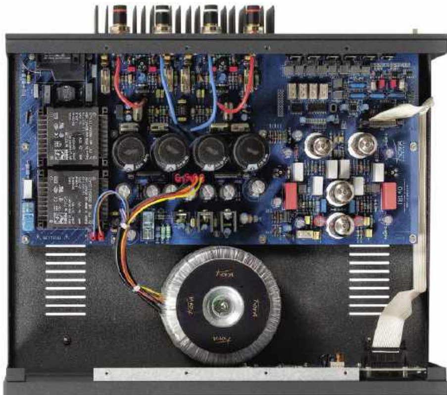
Pomimo rozbudowanego przedwzmacniacza, układy we wnętrzu sprawiają wrażenie kompaktowych; fragment końcówek mocy przeniesiono na zewnętrzny radiator.
