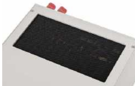
Spora „szczelina” wentylacyjna znajduje się w tylnej części górnej ścianki.
