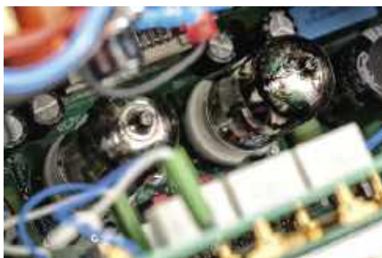
W przedwzmacniaczu pracują dwie podwójne triody 6922 Electro Harmonix.
