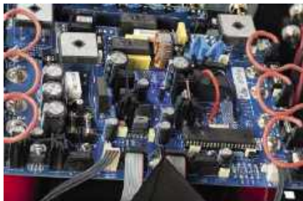
Górna, wyekspozowana płytki zawiera tylko elementy zasilacza układu sterowania.
