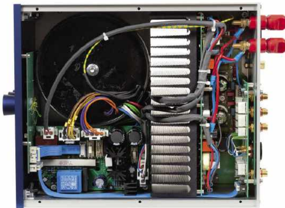
Przednią połowę obudowy zajmuje liniowy zasilacz, tranzystorowe końcówki i lampowy przedwzmacniacz znajdują się z tyłu.
