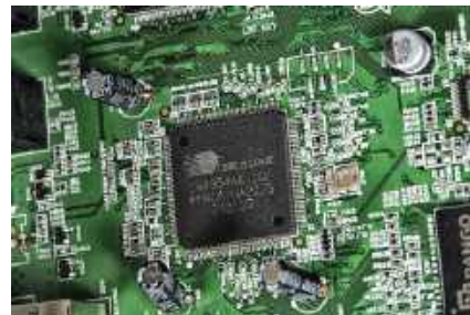
W obszarze dekodery surround Marantz konsekwentnie wykorzystuje układ firmy Cirrus Logic.
