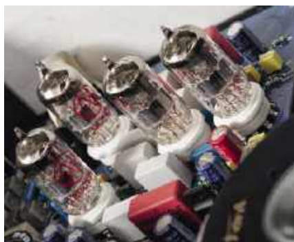
Sygnał o wysokim napięciu dostarcza tercet lamp ECC82/ECC83 JJ Electronic.
