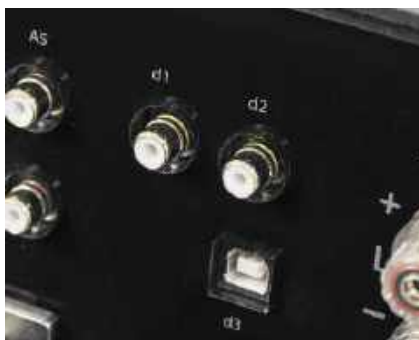
Aby aktywować wejścia cyfrowe, trzeba dokupić i zainstalować płytkę z przetwornikiem C/A.
