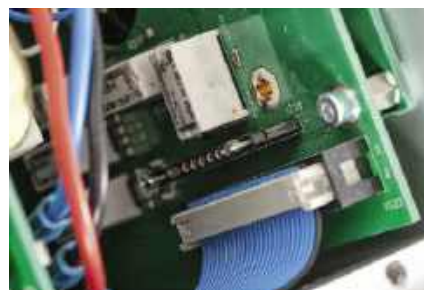
Szeroka taśma służy do przesyłania sygnałów sterujących, nie biegną nią sygnały audio.
