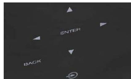
Za sterowanie odpowiadają sensory dotykowe; nie ma typowego pokręta wejść, a tylko jeden przycisk, który otwiera menu z listą źródeł.
