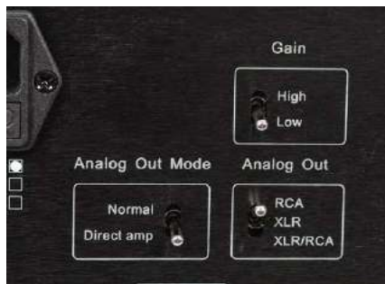
Trzy hebelki służą do ustalenia sposobu pracy wyjść analogowych.
