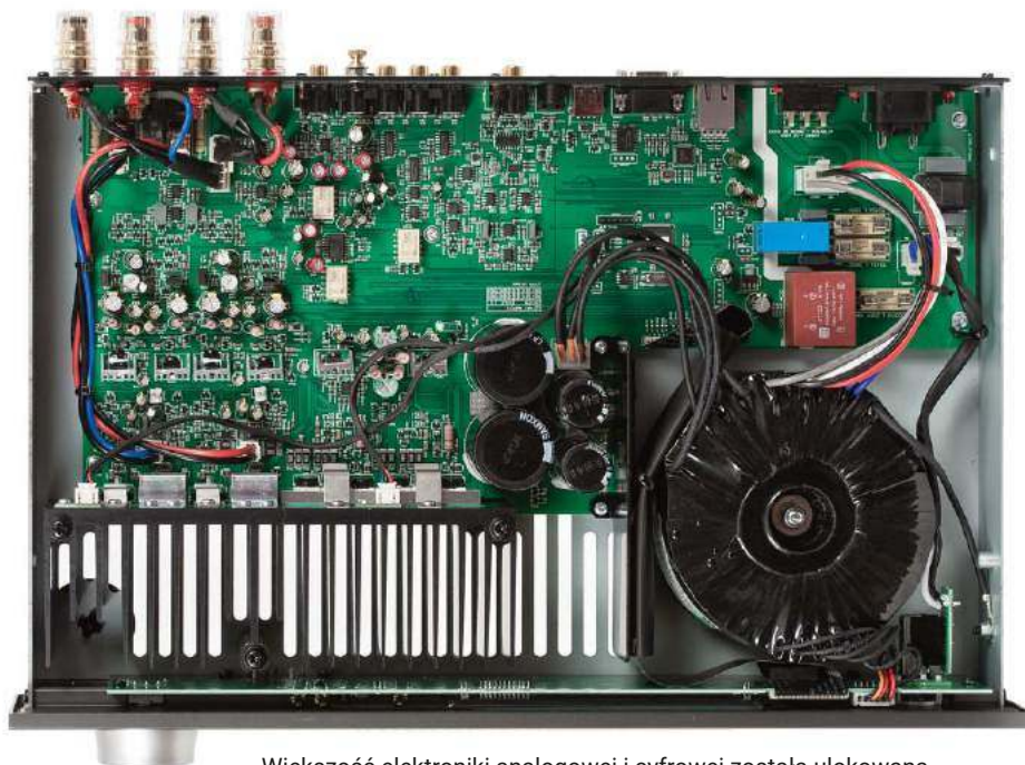
Większość elektroniki analogowej i cyfrowej została ulokowana na jednej dużej drukowanej płycie.
