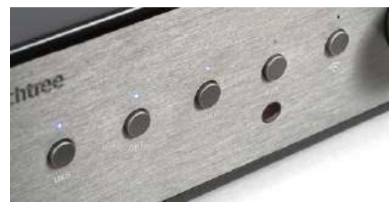
Podczas regulacji głośności poziom wskazują diody poszczególnych wejść.
