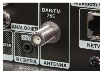
PMA-150H okazuje się nie tyle wzmacniaczem, co amplitunerem – zainstalowano w nim odbiornik FM/DAB.
