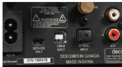
Oprócz funkcji sieciowych jest także USB-DAC, choć przyjmuje tylko sygnały PCM 24 bit/96 kHz.
