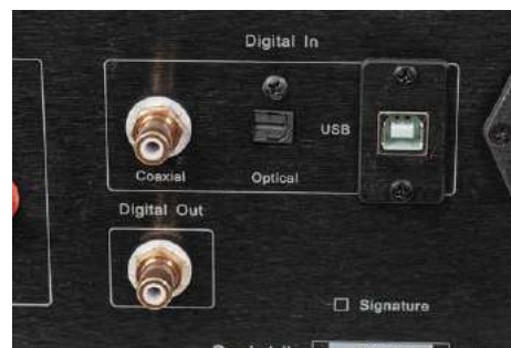
Gniazdo USB przyjmie sygnały PCM 24/384 i DSD128.
