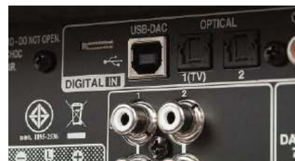
Wśród złączy cyfrowych jest USB-DAC, tą drogą prześlemy do urządzenia nawet sygnały PCM 32/384 i DSD256.
