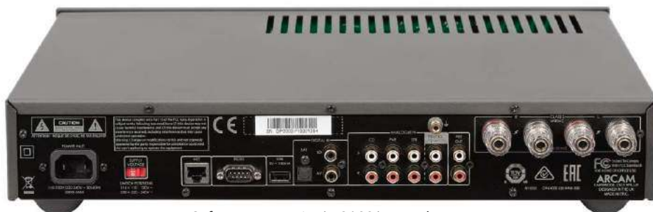
Cyfrowe wyposażenie SA20 jest podstawowe (złącza współosiowe i optyczne).
