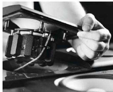
Kwadratowy panel na froncie obudowy jest zewnętrzną częścią skręcanego kosza. Jego konstrukcja pozwala na swobodne odprowadzenie fali od tylnej strony membrany, a także spod dolnego resora.
