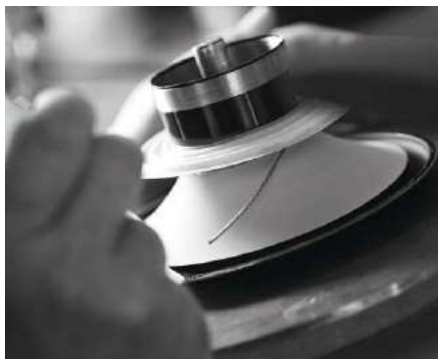
Dwucałowa cewka nawinięta jest płaskim drutem na tytanowym karkasie. Układ napędowy jest typu „krótka cewka – długa szczelina”, zapewnia niskie zniekształcenia kosztem niższej efektywności, którą można oczywiście podnosić, zwiększając siłę samych magnesów.
