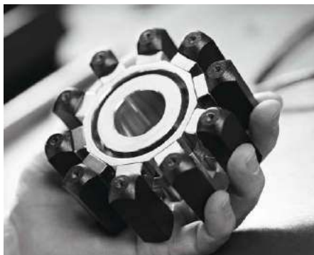
Dwa wieńce magnesów neodymowych (to małe „kostki” przyciśnięte przez większe czarne elementy) tworzą w szczelinie silne i jednorodne pole magnetyczne, a także strukturę pozwalającą na wentylowanie cewki (pomiędzy obydwoma wieńcami jest prześwit).
