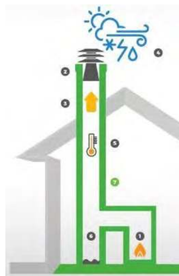
Rysunek 3. Regulator Ciągu Kominowego – system grzewczy bez regulatora: 1 – duże zużycie opału, 2 – duży poziom emisji zanieczyszczeń do atmosfery, 3 – zawiewanie, czyli cofanie spalin, 4 – praca systemu zależna od warunków pogodowych, 5 – zimny komin uniemożliwiający prawidłową pracę systemu, 6 – znaczna ilość kondensatu, 7 – erozja komina spowodowana zawilgoceniem komina
