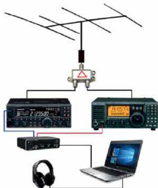
Rys. 14. Schemat blokowy podłączenia interfejsu
