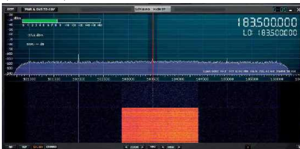
Rys. 11. Filtr notch dla pasma DAB+
