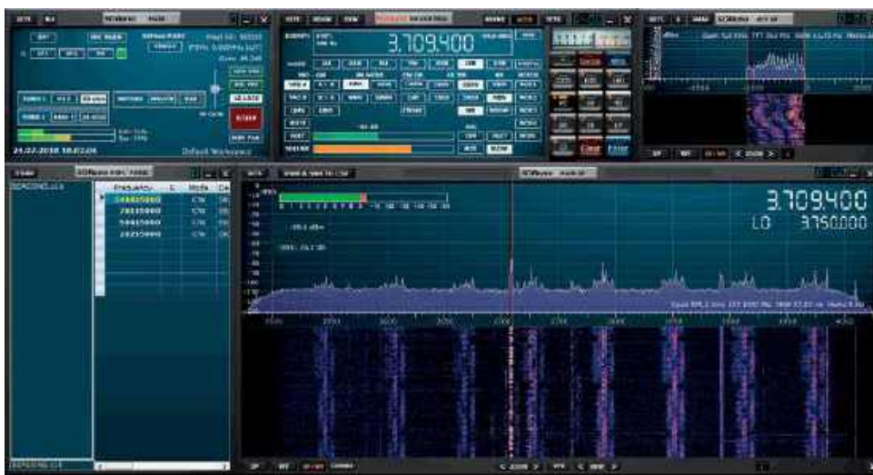
Rys. 8. Odbiór stacji amatorskiej na paśmie 40 m nadającej z modulacją PSK
